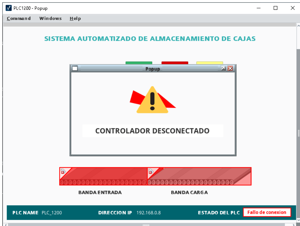
Figura 107. Ventana emergente por desconexión de PLC.
