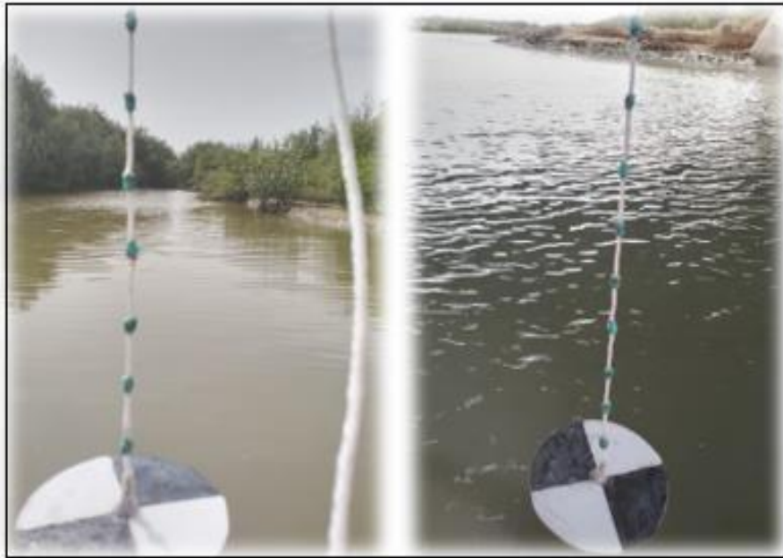
Figura 55. Toma de muestras con el disco secchi para turbidez
