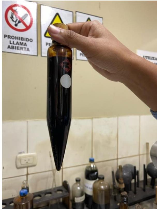
*Figura 29 Lectura y registro del volumen agua y sedimentos de la muestra 1.*
