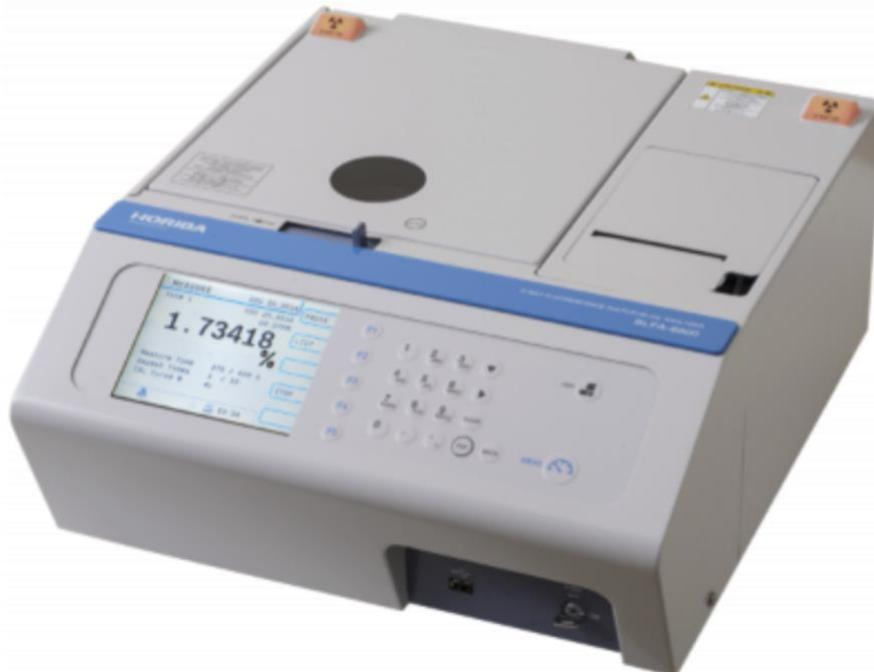
*Figura 32 Analizador de Azufre en petróleo y derivados - SLFA-600 Serie Fluorescencia de rayos X (Domínguez, 2020).*
