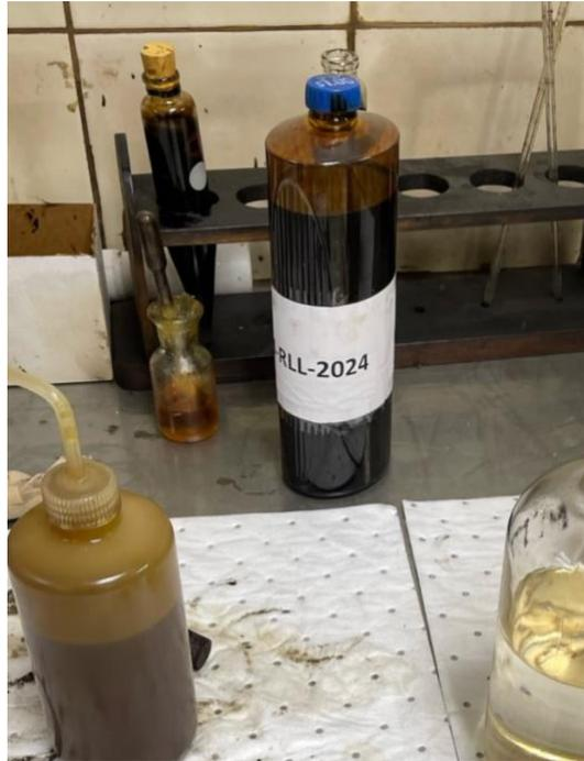
*Figura 31 Mezcla de 50 ml de solvente y 50ml de la muestra 3.*
