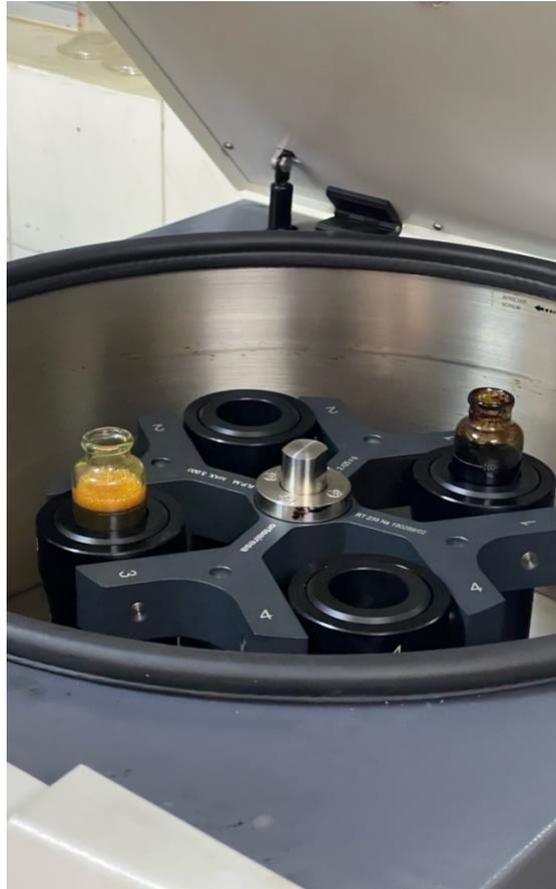
Figura 25 Tubos de la muestra 2 y 3 en portatubos opuestos.
