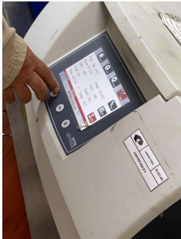
Figura 26 Inicio de la Centrifugación a 70C por 15 min a 1500 rpm.
