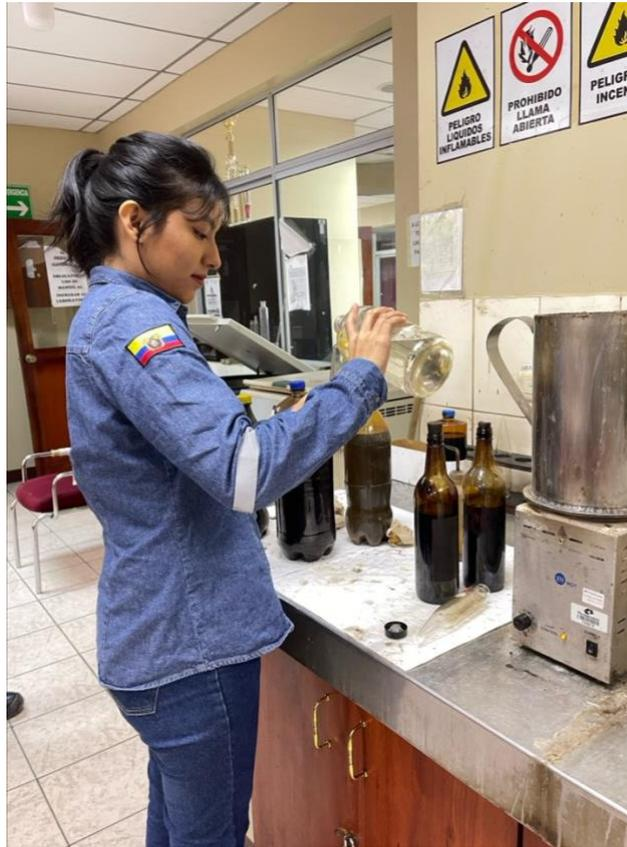
*Figura 21 Mezcla de 50 ml de solvente y 50ml de la muestra 1.*
