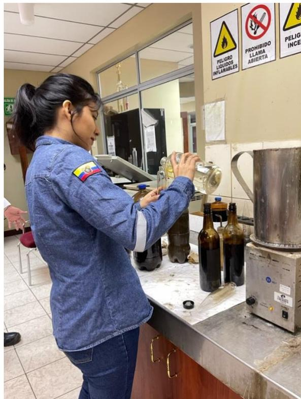
*Figura 24 Mezcla de 50 ml de solvente y 50ml de la muestra 2 y 3.*
