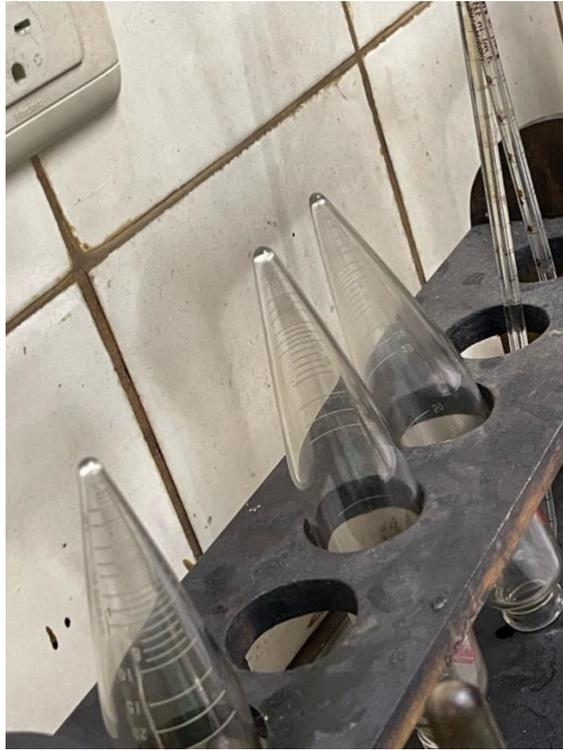
*Figura 19 Los 3 tubos de centrifugación para el análisis de agua y sedimentos.*
