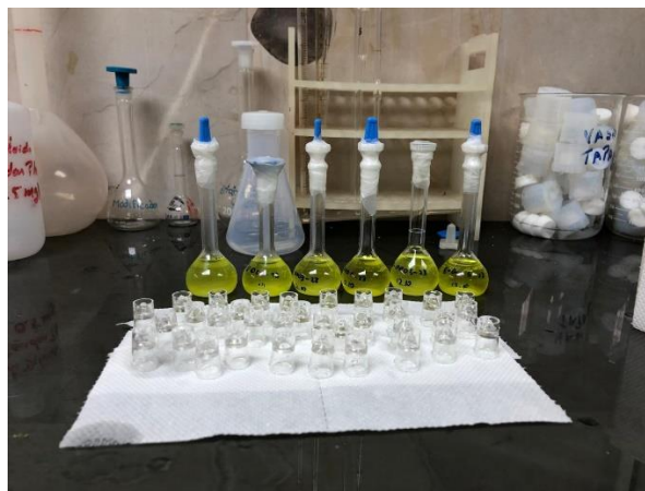
Figura 10. Muestras procesadas listas para ser analizadas en espectrofotómetro de absorción atómica Fuente: INOCAR, Cabrera Stephany, (2024).
