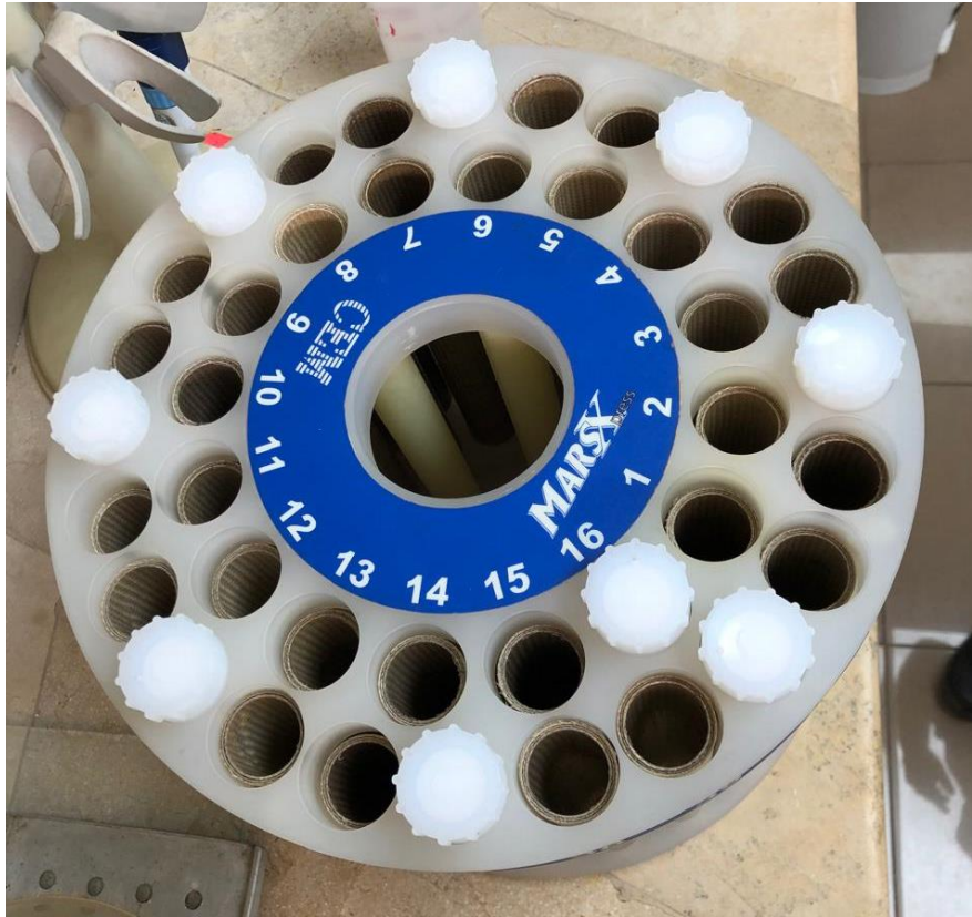
Figura 5. Distribución de tubos de digestión en gradilla para horno MarsX
