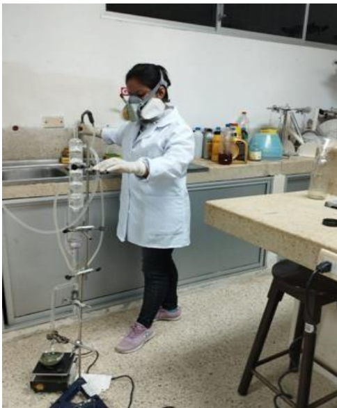
Anexo 11. Representación del método Soxhlet.
