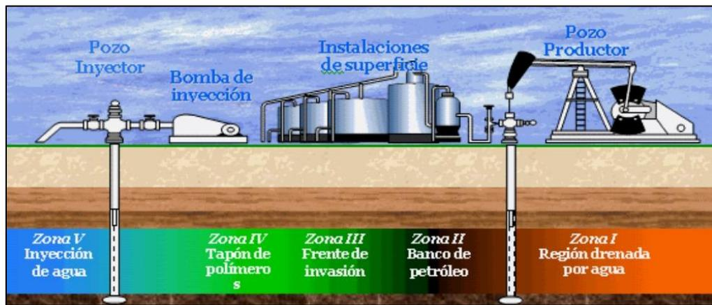
Figura 10. Diagrama esquemático de una inyección de polímeros, (Blogspot, 2013).
