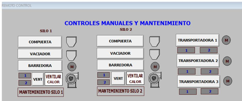
**Figura 52.** Ventana de control manual/remoto del SCADA. [Fuente: Creado bajo las normas ISA 101.01]
