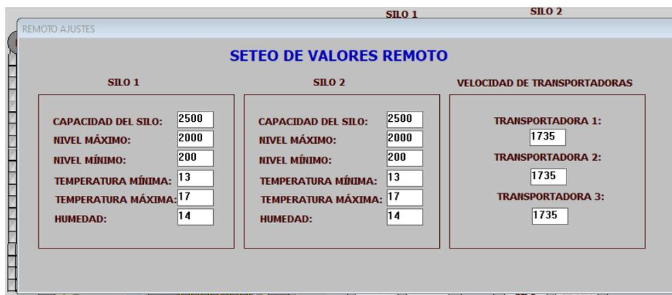
Figura 63. Valores establecidos en la ventana de ajustes del SCADA. [Fuente: Creado bajo las normas ISA 101.01]
