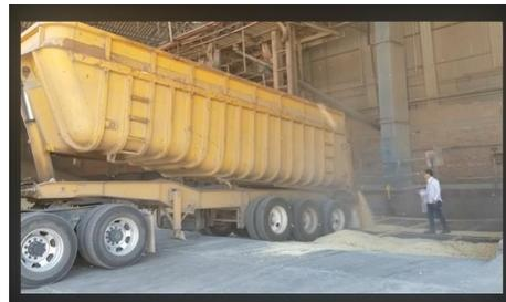
*Figura 2: Vaciado de producto al granel. [14]*
