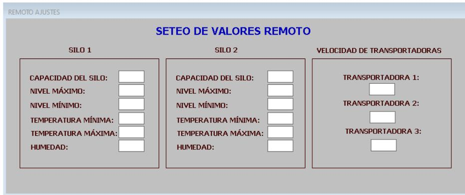
**Figura 51.** Ventana para el cambio de valores en modo remoto. [Fuente: Creado bajo las normas ISA 101.01]
