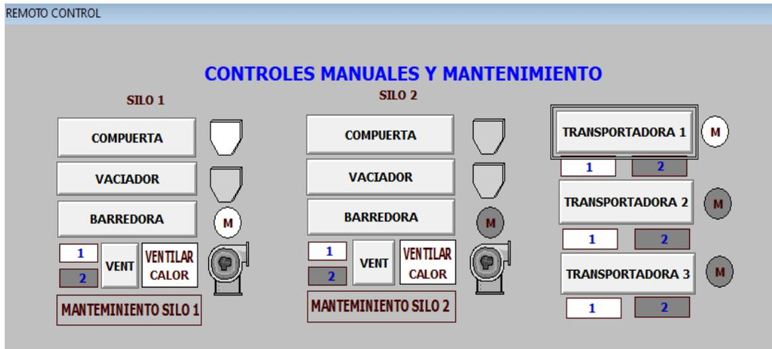
Figura 60. Controles Manuales del SCADA en operación. [Fuente: Creado bajo las normas ISA 101.01]
