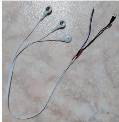
**Figura 52.** Cable para electrodos modificado.
