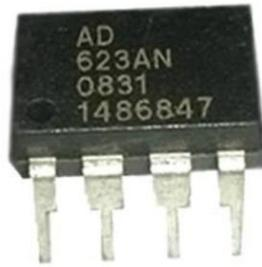
**Figura 25.** Circuito integrado del Amplificador de instrumentación AD623.
