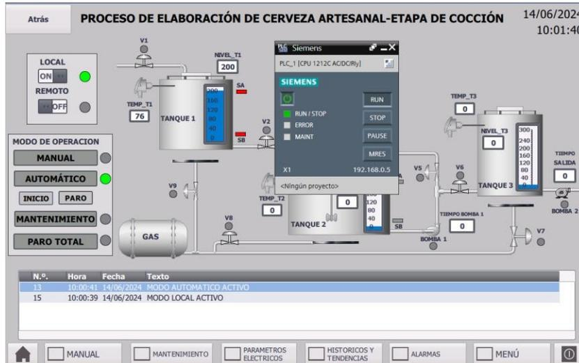
Figura 20. Función en modo automático llenado de tanque 1 (Kevin Malán)
