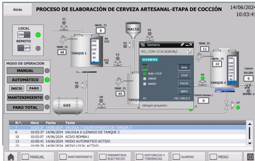
**Figura 22.** Función en modo automático llenado de tanque 3 y adición de lúpulo (Kevin Malán)
