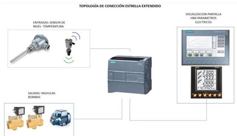
Figura 8. Diagrama topológico de conexión estrella extendida (Kevin Malán)
