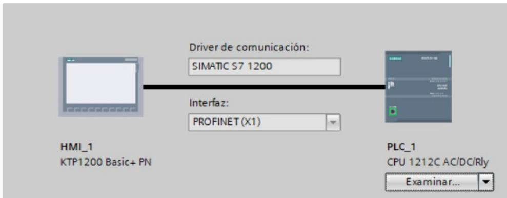
**Figura 9.** Configuración de conexión entre PLC y HMI (Kevin Malán)
