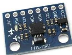
**Figura 15.** Representación real del dispositivo MPU6050 [63].
