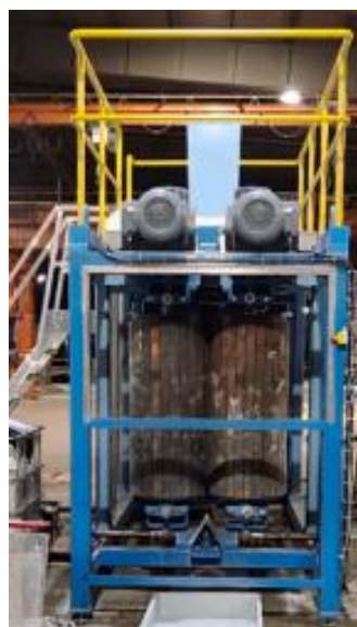
Figura 19. Trituradora de compresión continua a escala piloto.
