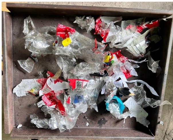
Figura 57. Resultados de la trituración de botellas.
