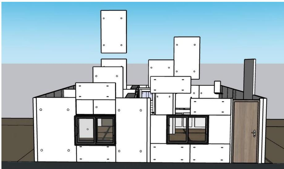
La estructura está compuesta por acero, un material ligero y de fácil instalación, lo que acelera el proceso constructivo. Las paredes y pisos utilizan placas de fibrocemento, promoviendo la modularidad y adaptabilidad a diferentes entornos. Esta elección de materiales asegura durabilidad y minimiza el impacto ambiental, alineándose con las tendencias de construcción sostenible.
