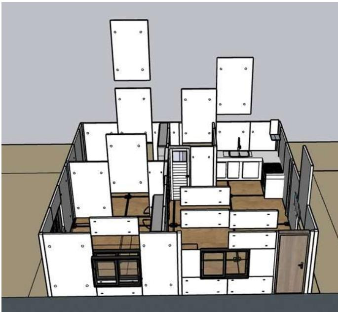
Instalación de los paneles prefabricados de hormigón con vidrio triturado en paredes
