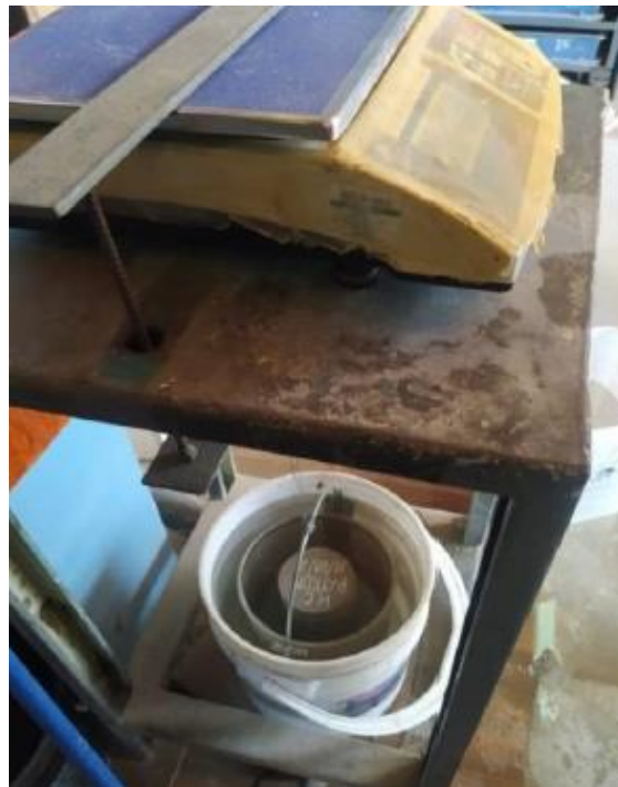
Figura 15 Peso específico y absorcion del hormigón
