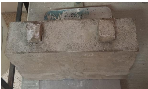
Figura 16 Machihembrado en la parte sup e inf
