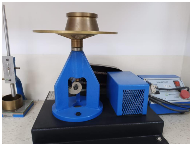
Figura 11 Fluidez de la mezcla de hormigon celular
