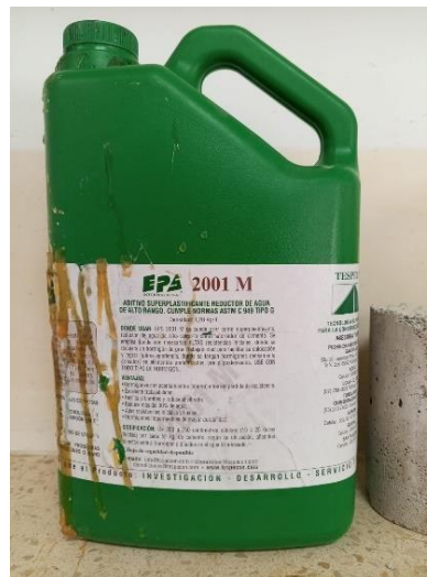
Figura 4._ Aditivo superplastificante reductor de agua
