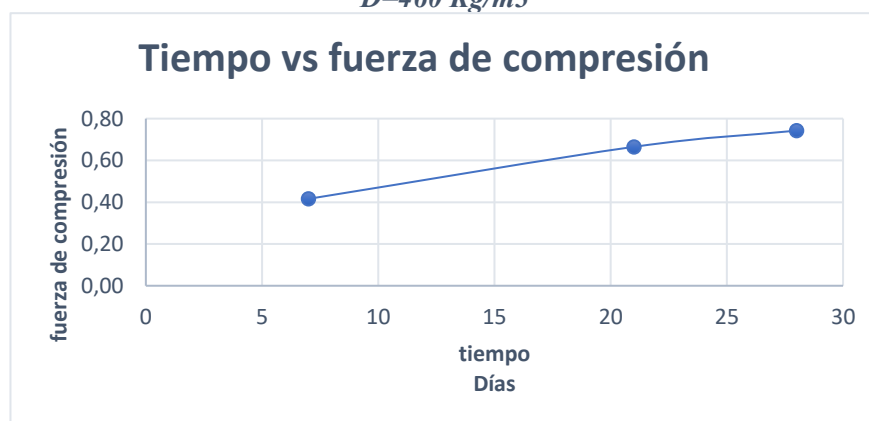
Figura 20 Curva reistencia a la compresión de las muestras con espuma de densidad D=460 Kg/m 3
