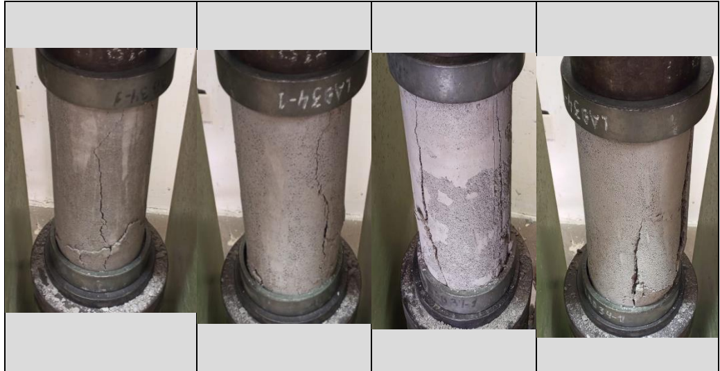
Figura 14 Ensayo de Resistencia a la compresion
