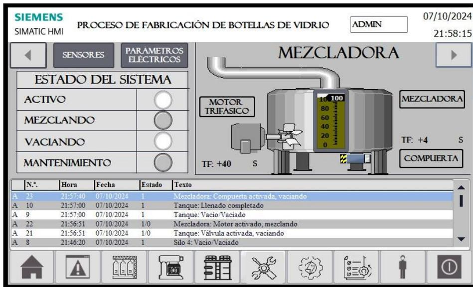
Figura 64: Mezclador en etapa de vaciado
