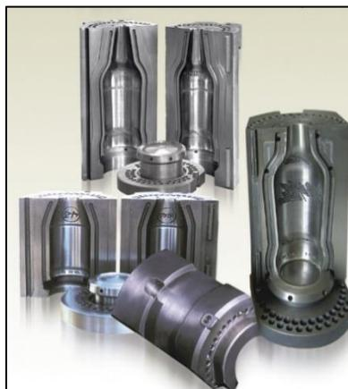
Figura 22: Distintos moldes para botellas de vidrio [17]
