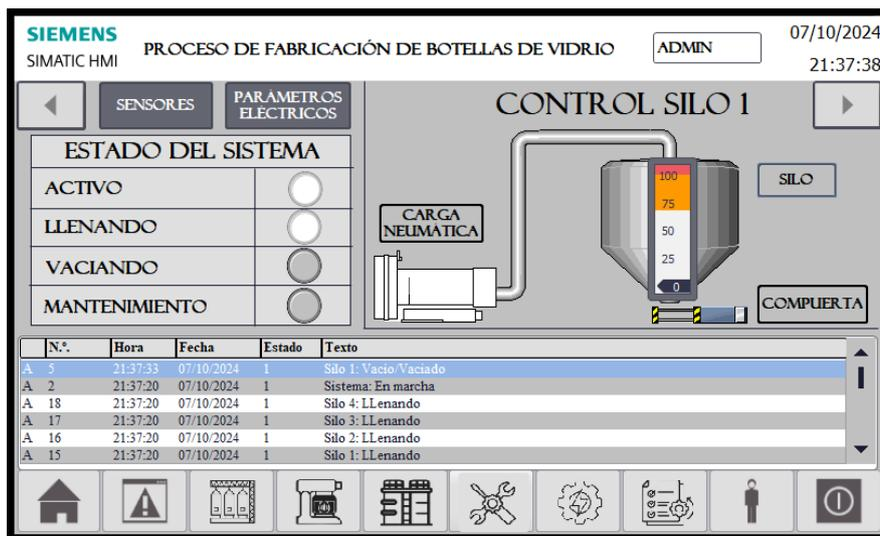
Figura 60: Carga neumática activa en silo
