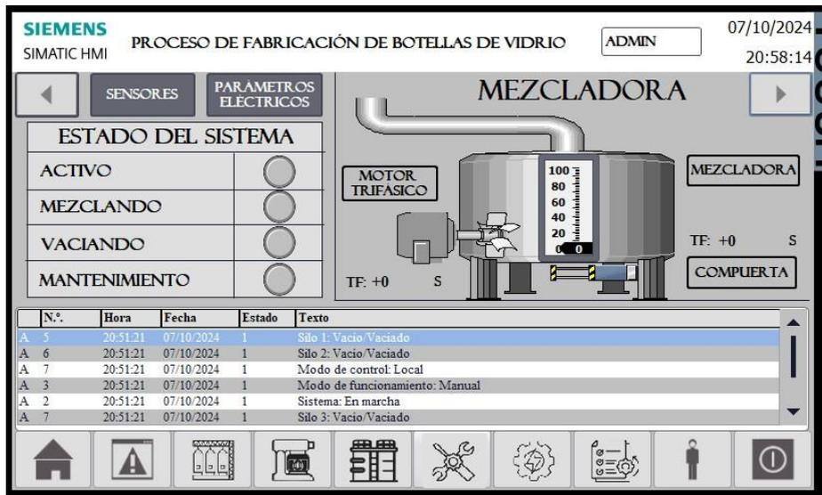
Figura 54: Controles de la mezcladora
