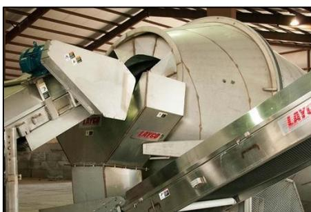
Figura 20: Mezclador rotativo industrial [15]
