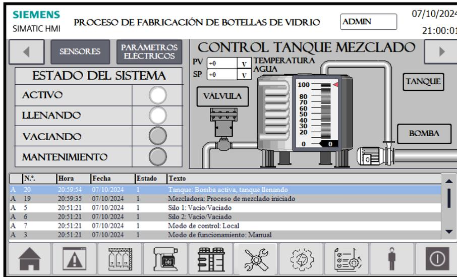
Figura 55: Controles del llenado de tanque
