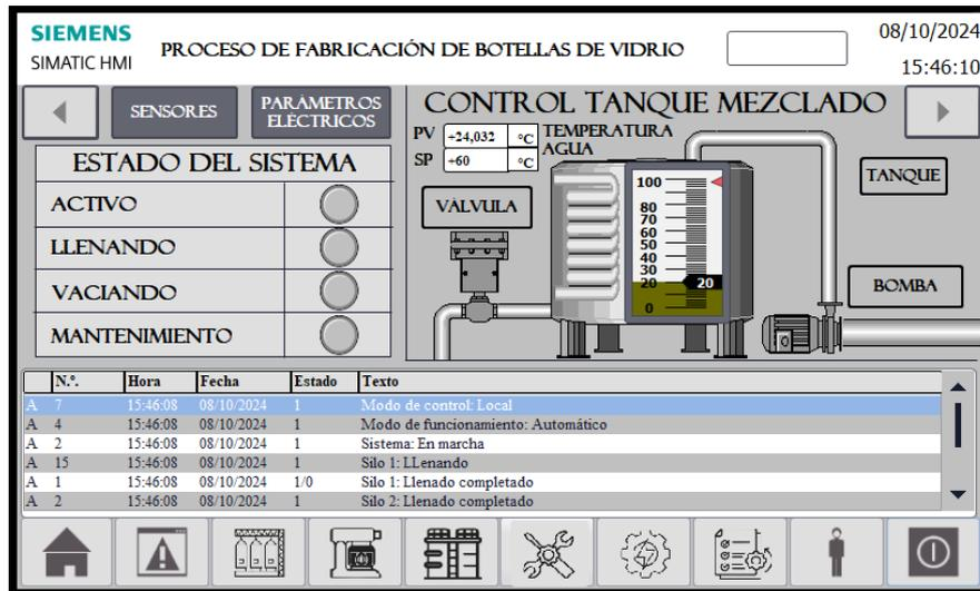
Figura 62: Valores de controlador de temperatura en tanque de agua
