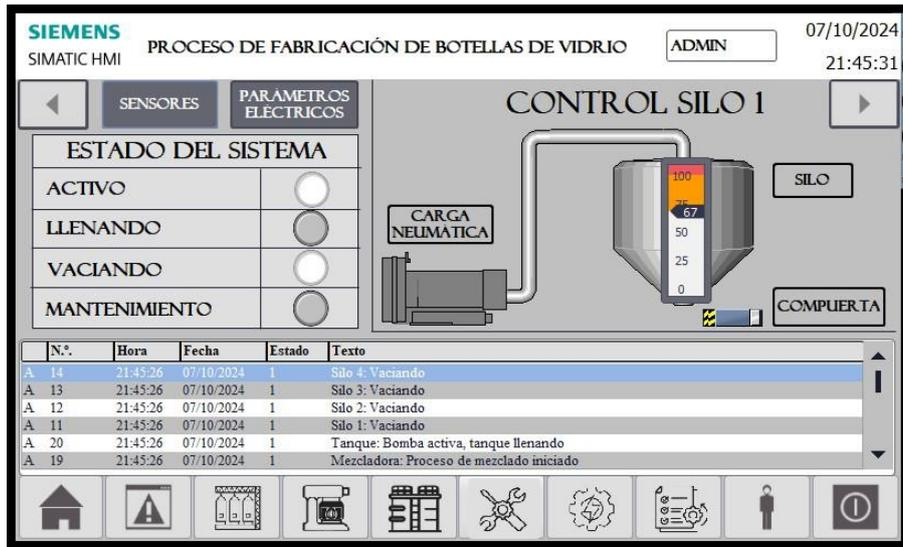
Figura 61: Carga neumática inactiva en silo lleno
