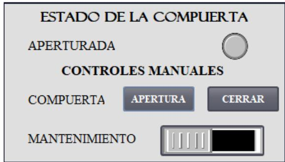
Figura 53: Ventana emergente de controles de compuerta
