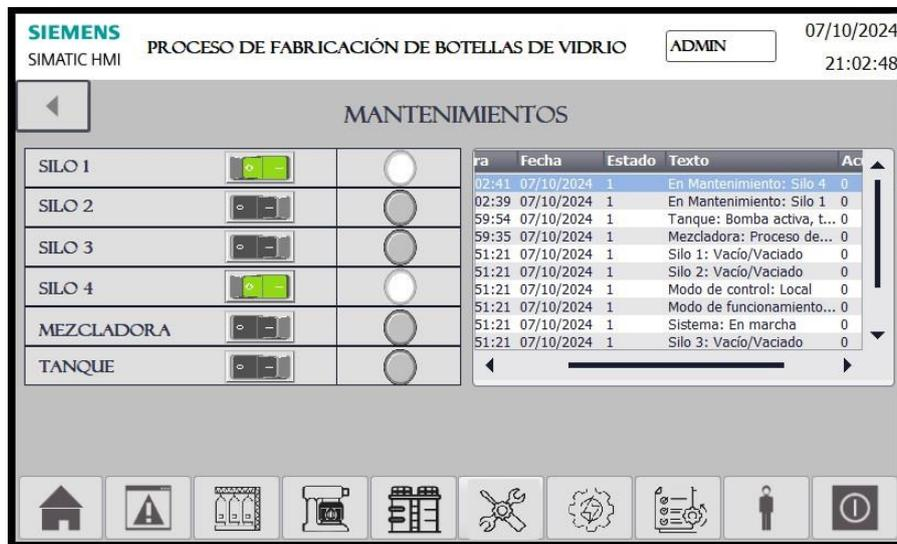
Figura 56: Pantalla de mantenimientos
