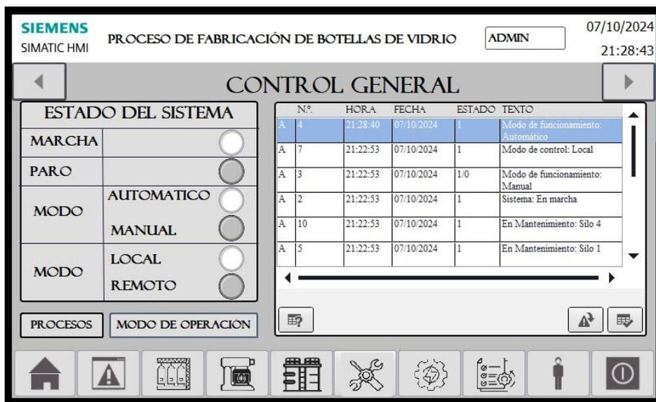
Figura 58: Sistema en modo automático
