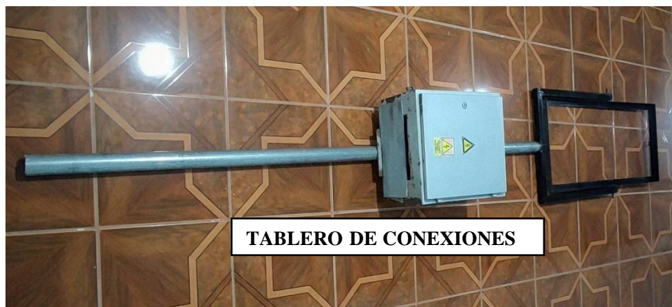
Figura 44. Tablero de conexiones
