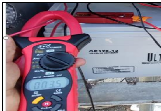
Figura 55. Corriente que ingresa del panel al controlador.
