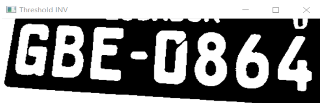
Figura 41 Threshold binario inverso transforma la imagen recibida en binaria B/N resaltando los caracteres
