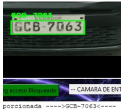
Figura 50 Lectura de caracteres de placa con ligero desgaste a una distancia de 2 metros
