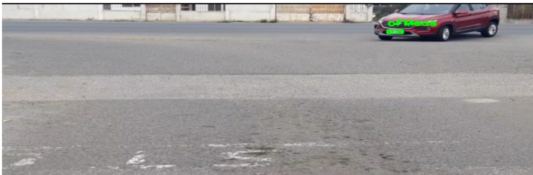
Figura 75 Placa detectada a una distancia aproximada de 20 metros
