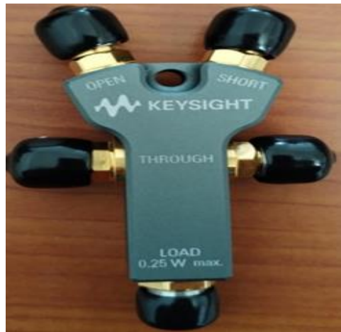
Ilustración 9. Keysight Cal Kit 85520a
