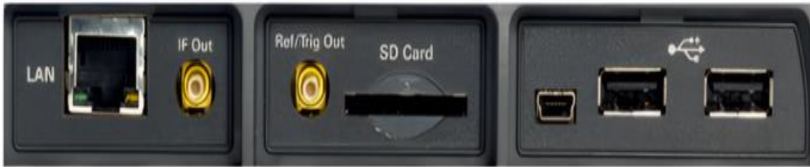
Ilustración 5. Panel Lateral Derecho del Analizador FieldFox [12]
