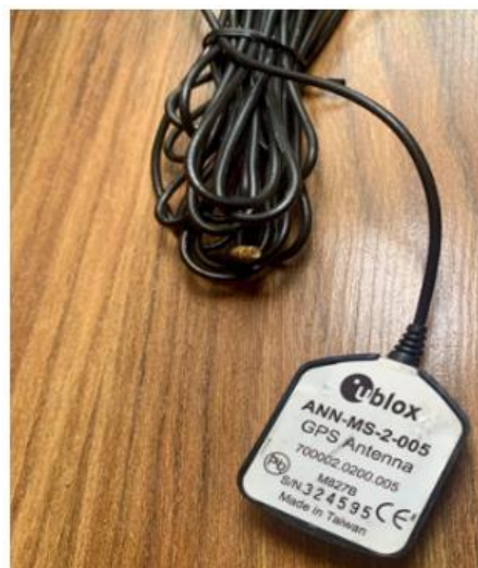
Ilustración 10. Antena GPS u-blox ANN-MS- 0-005
