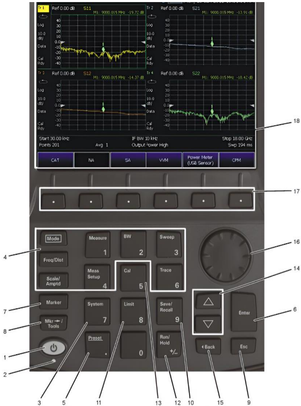
Ilustración 3. Panel frontal del Analizador FieldFox [12]
