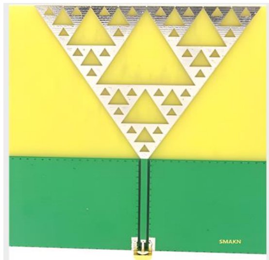
Ilustración 8. Antena Parche a Doble Banda con Geometría Fractal
