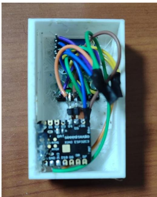
*Figura 22. Conexión entre los sensores y el microcontrolador*
