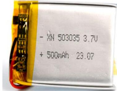
*Figura 8. Batería de litio 3.7v [34]*
