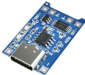
Figura 15 Modulo cargador de batería litio
