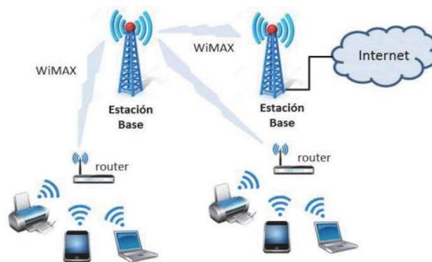
Figura 9. Diagrama de una red WiMAX
