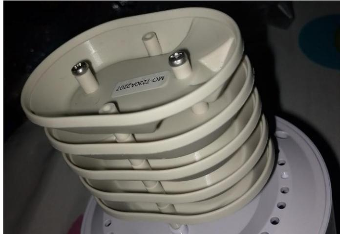
*Figura 11. Sensor Termómetro e higrómetro*
