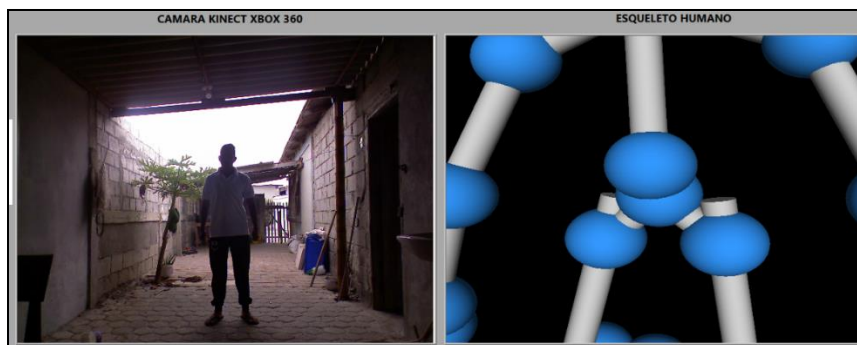
Figura 72. Prueba luminosidad - Baja.
