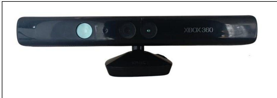
Figura 19. Cámara Kinect 360° [Fuente: Autor].
