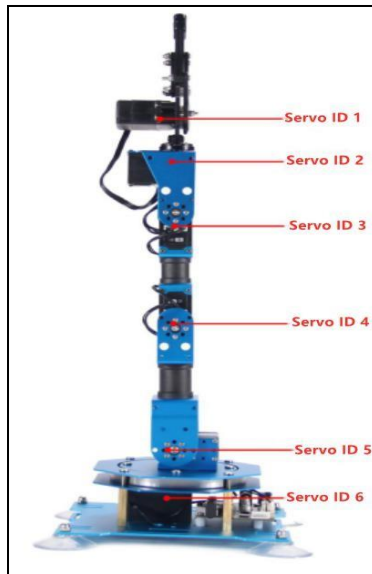
Figura 24. Distribución de los servos en el brazo robótico [72].
