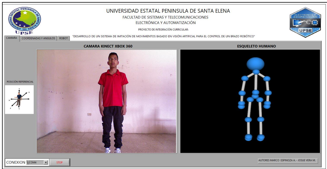
Figura 69. Ventana principal de interfaz del sistema de imitación en LabVIEW [Fuente: Autor].
