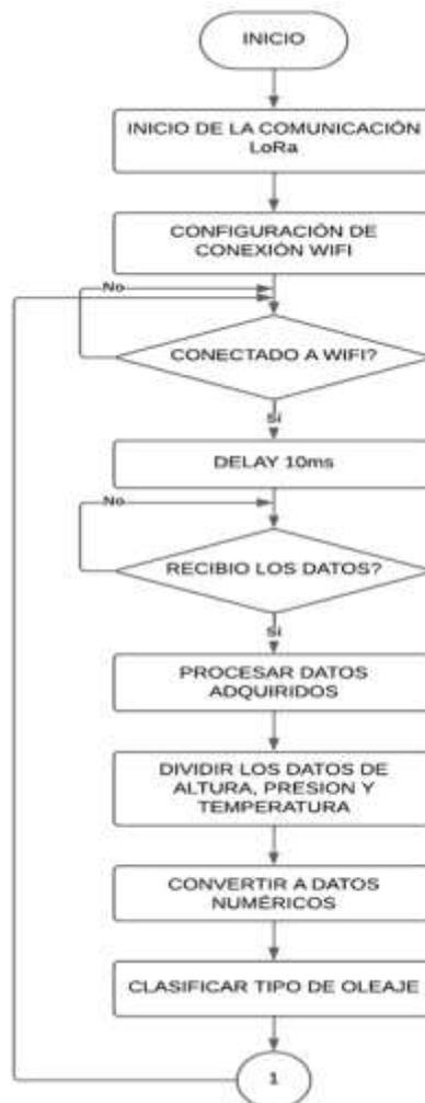
Figura 59 Diagrama de flujo del receptor parte 1. Fuente: Autoría propia
