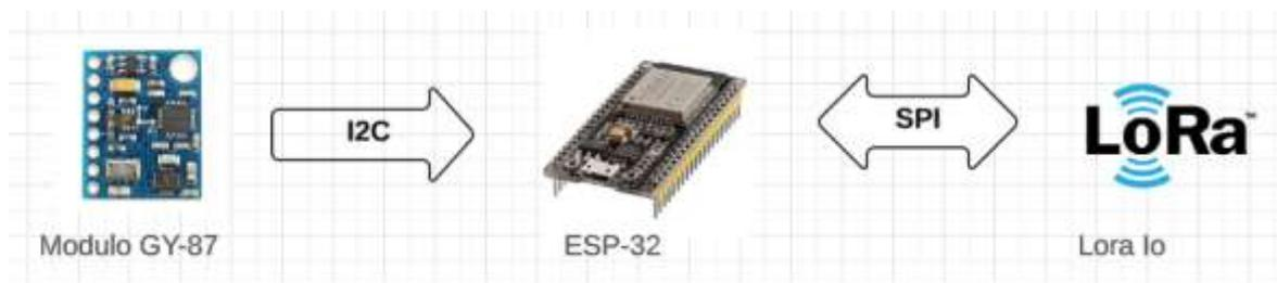
*Figura 4 Diseño de adquisición de datos. Fuente: Autoría propia*
