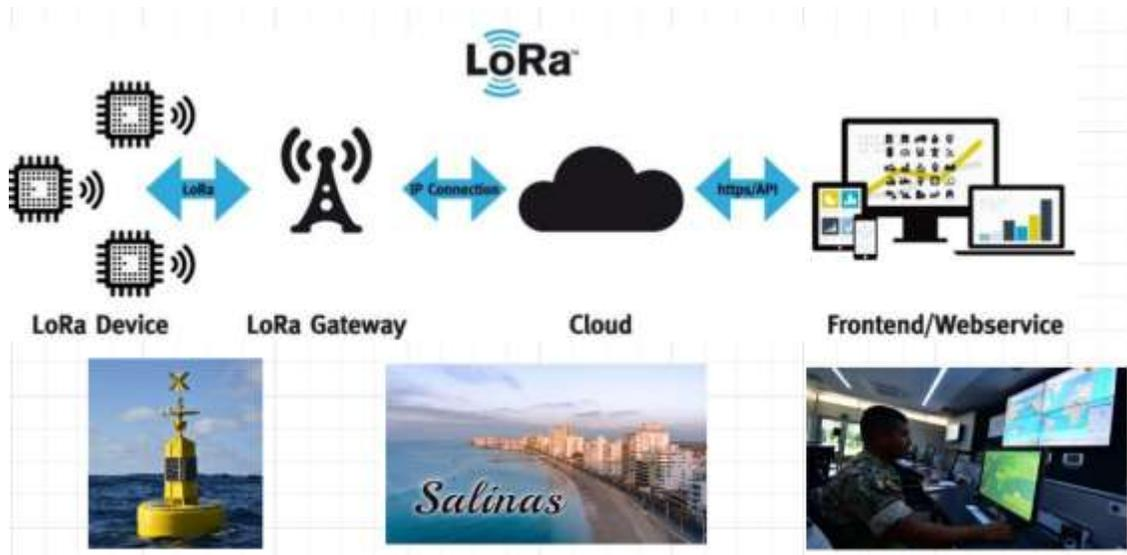
*Figura 2 Flujo básico de comunicación en una arquitectura LoRa. Fuente: Autoría propia*
