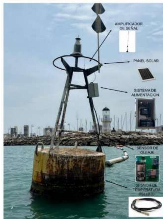
*Figura 38 Sistema de Monitoreo Marítimo con Sensores y Alimentación Autónoma. Fuente: Autoría propia*
