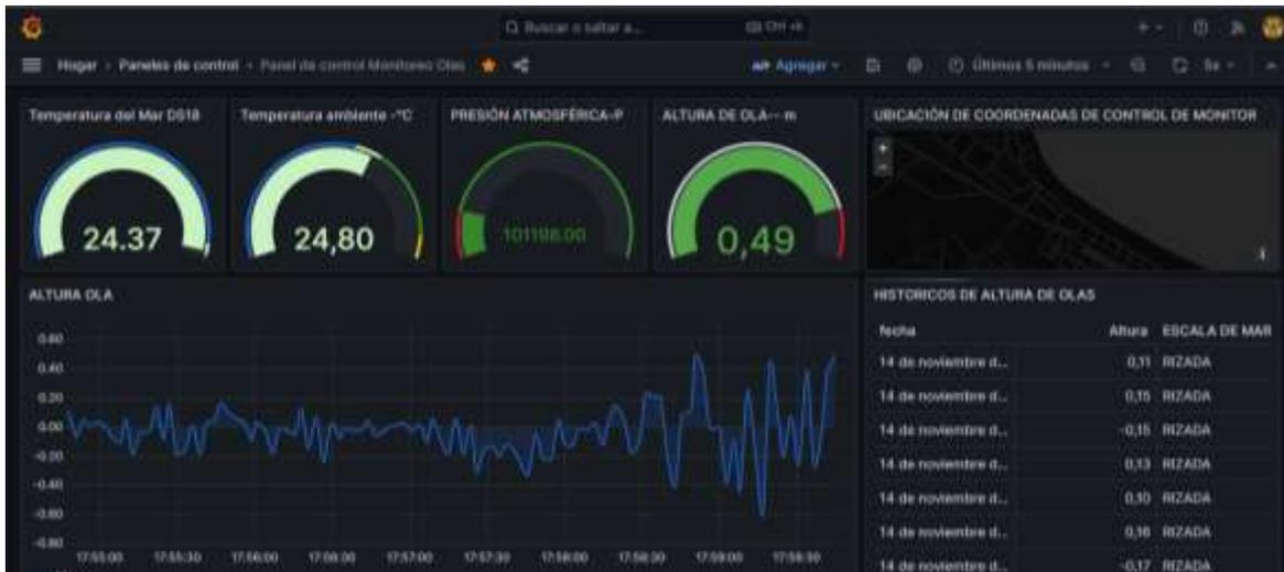
**Figura 88** Monitoreo en tiempo real de la altura de olas y condiciones ambientales. Fuente: Autoría Propia
