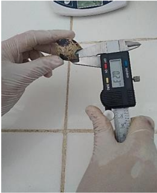
Anexo 16 Utilización de calibrador digital en la medición del grosor de cascara del huevo
