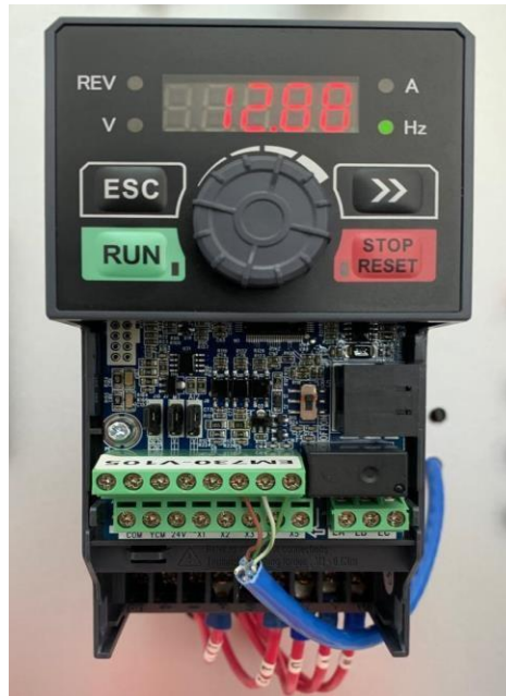
Figura 41. Conexión del variador de frecuencia SINEE. Fuente:[24].
