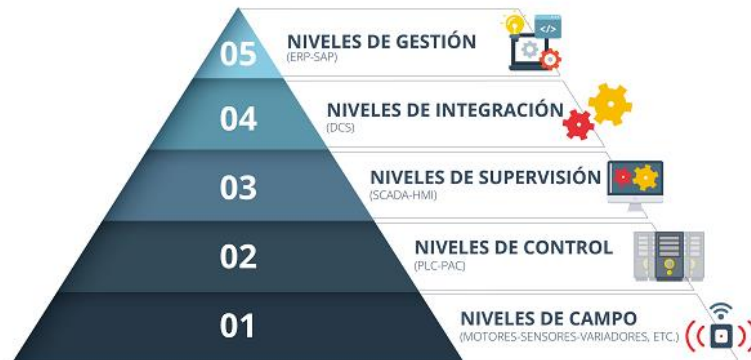
Figura 6 Pirámide de automatización. Fuente: [11].
