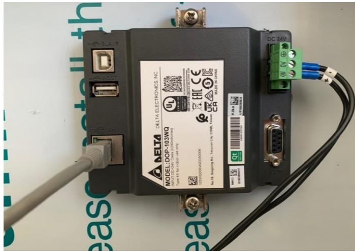
Figura 48. Conexión del HMI Delta DOP-103WQ. Fuente: [24]
