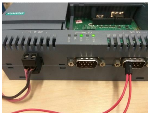
Figura 46. Conexión de la pasarela SIMATIC IOT2040. Fuente: Autoría propia.
