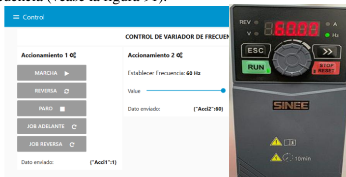
Figura 112. Accionamiento de variador mediante interfaz remota. Fuente: Autoría Propia
