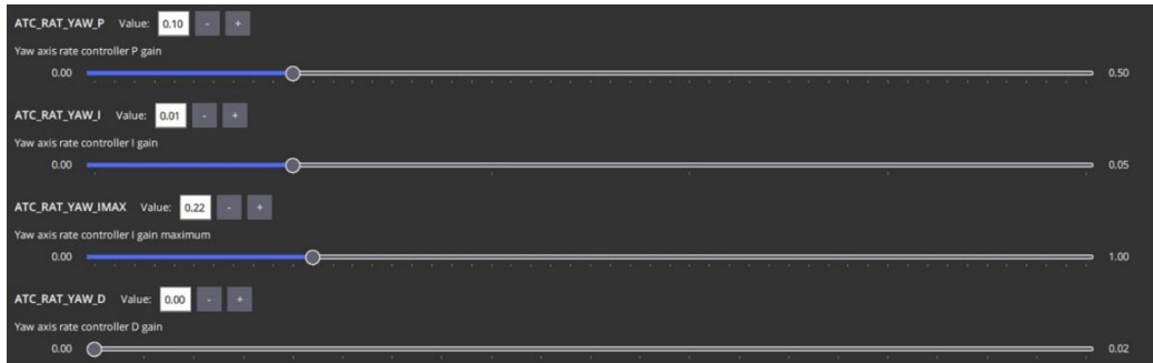
Figura 169: Configuración de parámetro Yaw Imagen elaborada por el autor
