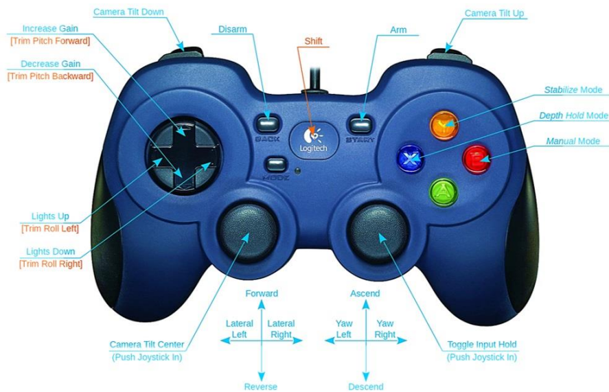
Figura 153: Configuración predeterminada de botones del joystick [43].
