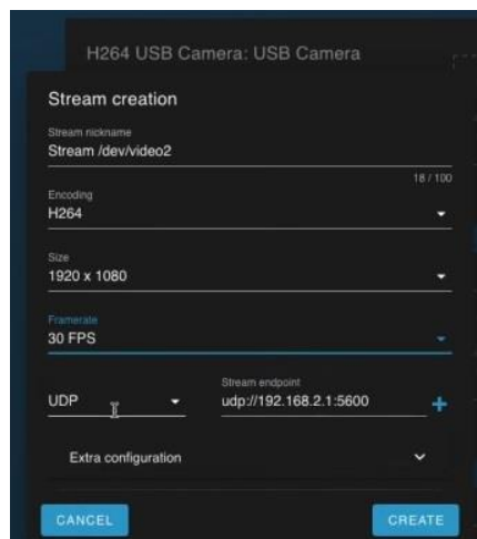
Figura 73: Configuración para habilitar la transmisión de video en la interfaz de BlueOS Imagen elaborada por el autor
