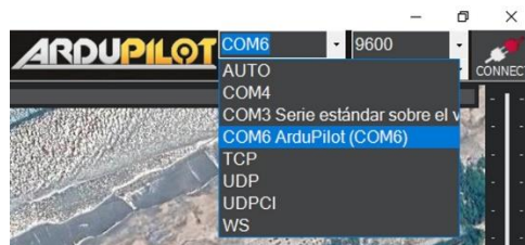
Figura 140: Seleccionamos el Puerto COM6 ArduPilot (COM6)
