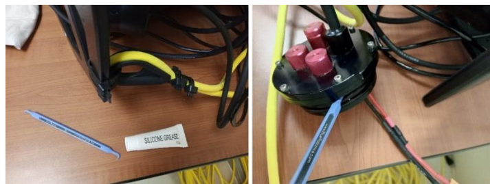
Figura 170: Colocación de grasa de silicona a las juntas tóricas
