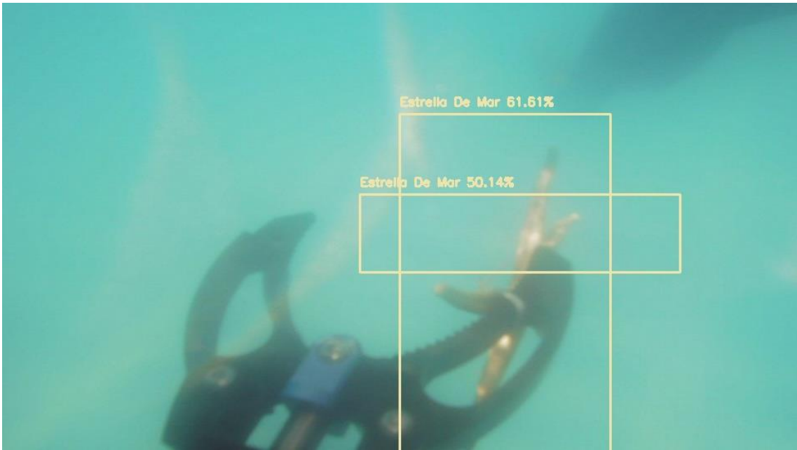
Figura 97: Predicciones erróneas realizadas bajo el agua por el modelo entrenado Imagen elaborada por el autor
