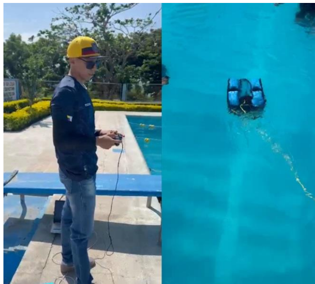
Figura 99: Maniobras del robot submarino con el joystick en modo manual
