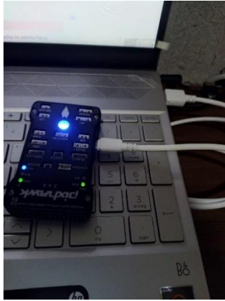
Figura 139: Pixhawk conectada a PC por medio de cable USB-Micro USB
