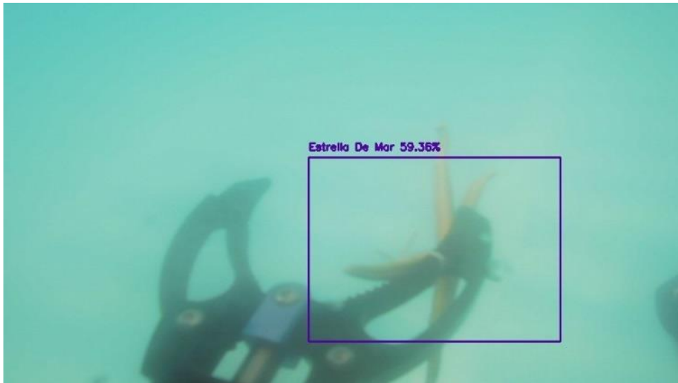
Figura 93: Desplazamiento de la estrella de mar durante pruebas presenta una precisión de 59.36%
