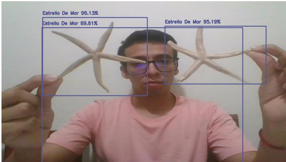
Figura 83: Presencia de falso positivo del modelo entrenado a 1000 iteraciones Imagen elaborada por el autor
