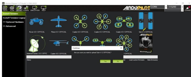
Figura 141: Instalación de Firmware Sub en Mission Planner
