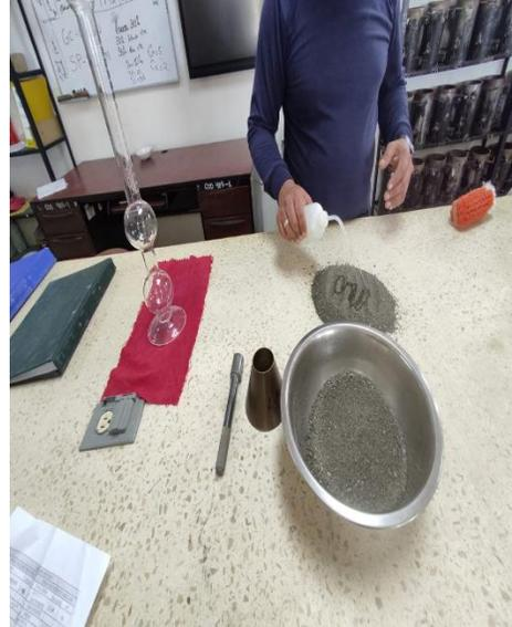
Ensayo de densidad y absorción del agregado fino
