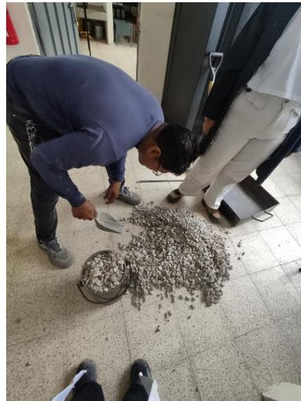
Peso volumétrico varillado del agregado grueso, peso volumétrico suelto del agregado grueso y fino
