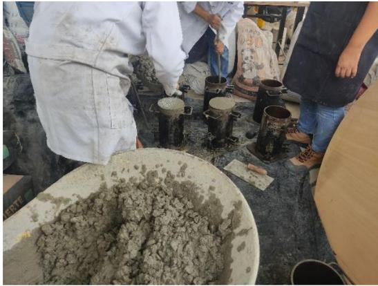
*Ilustración 7 Elaboración de los grupos testigos de hormigón*
