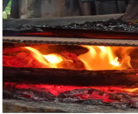
*Ilustración 3 Calcinación de la cascara de papa a 500°C*
