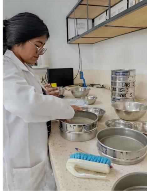
Ensayo de granulometría del agregado grueso y fino
