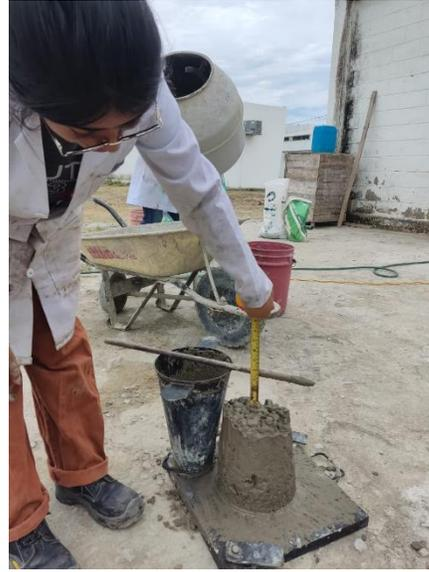
Ensayo de revenimiento – Cono de Abrams
