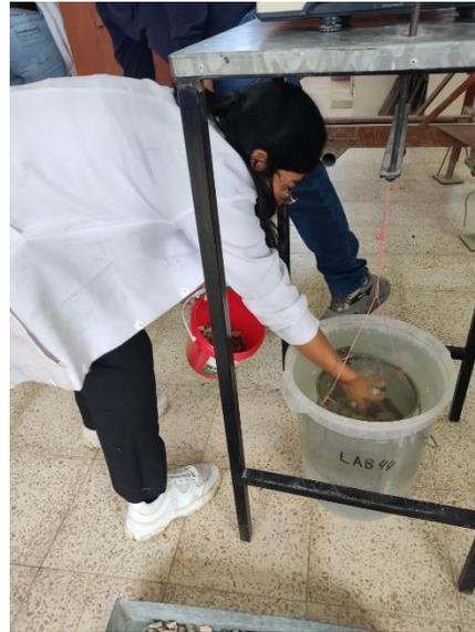
Ensayo de densidad y absorción del agregado grueso
