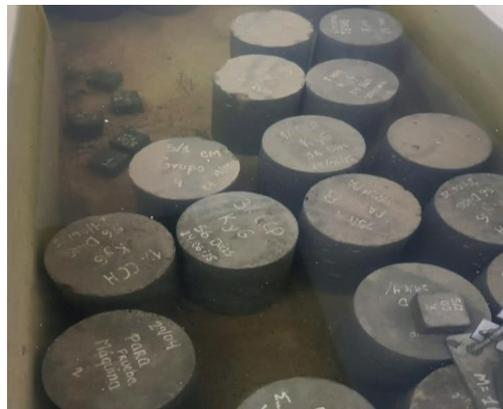
*Ilustración 8 Curado de testigos de hormigón*
