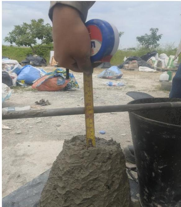
*Ilustración 6 Prueba de revenimiento - Cono de Abrams*
