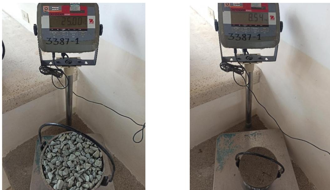
*Nota:* Determinación de pesos volumétricos de los agregados grueso y fino.
