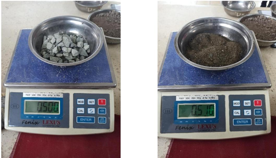
*Nota:* Determinación de la humedad de los agregados.
