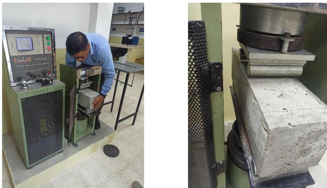
*Nota:* Roturas de vigas, ensayo a flexión.
