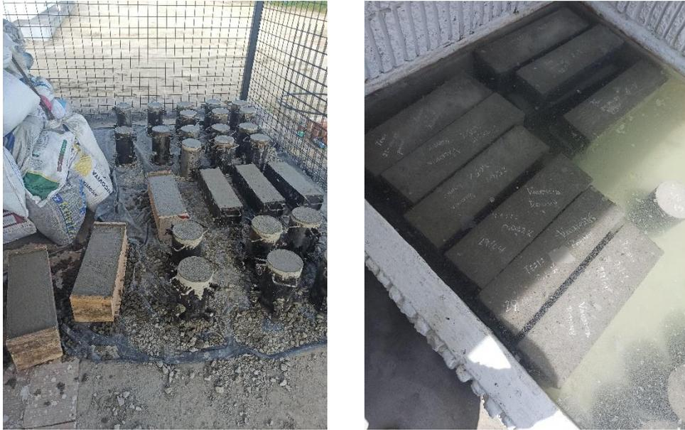
*Nota:* Elaboración de las vigas de hormigón y curado en la piscina.
