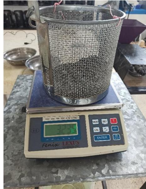
*Nota:* Determinación de la densidad de los agregados.
