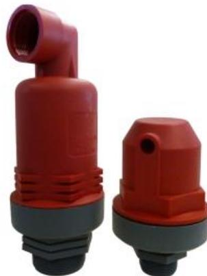
Una de las principales ventajas de estas válvulas es su funcionalidad trifuncional, ya que permiten: la entrada de aire cuando la tubería se vacía, la salida de aire cuando se llena la tubería y la salida continua de aire durante el funcionamiento normal del sistema.
