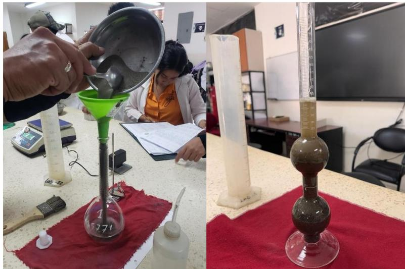
**3.9.1.4. Ensayo de cono para determinar el estado Saturado Superficialmente Seco (S.S.S.) del agregado fino**
