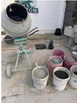
El proceso para mezclar empezó por añadir primero el agregado grueso, seguidamente por la mitad del agua, y depuse el agregado fino, terminando con el cemento o la combinación de cemento y CCA más el resto del agua. Se mezcló hasta obtener una consistencia pareja, como se ve en la figura 28. Las cantidades empleadas fueron determinadas por el método ACI 211.1, teniendo en cuenta pruebas previas a los agregados.
