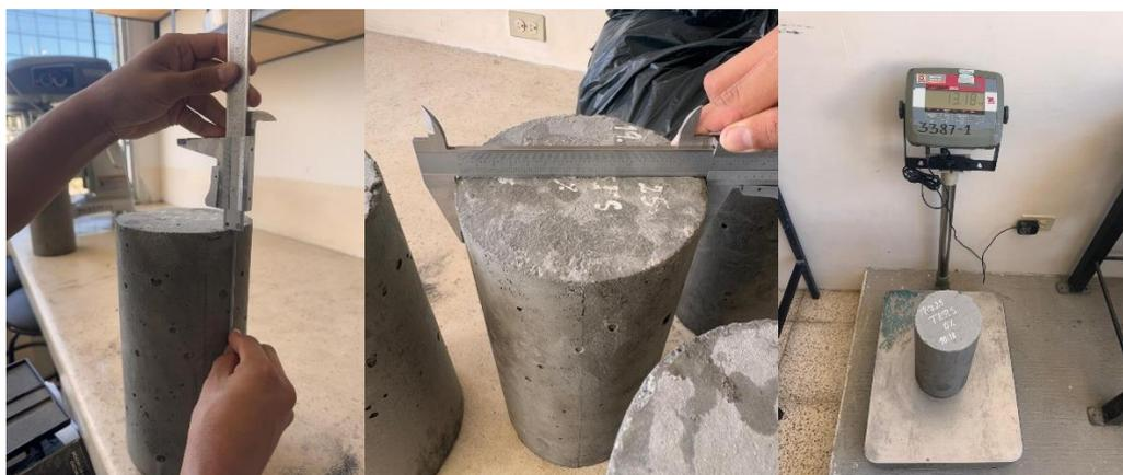
En medio del proceso, las probetas se colocaron bien centradas, encima de superficies planas y niveladas. La carga se aplicó de forma continua y uniforme, sin
