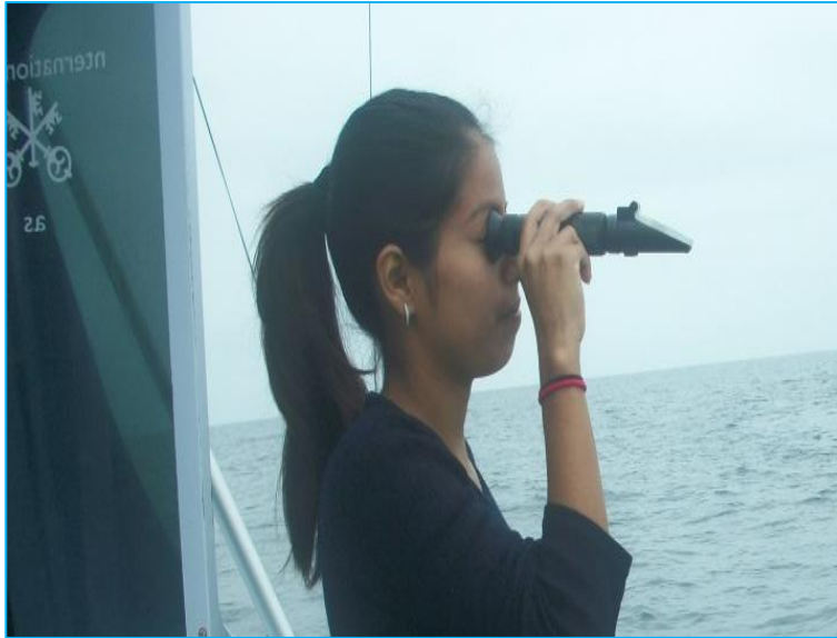
Foto 9.- Medición de parámetros ambientales, Salinidad del agua de mar
