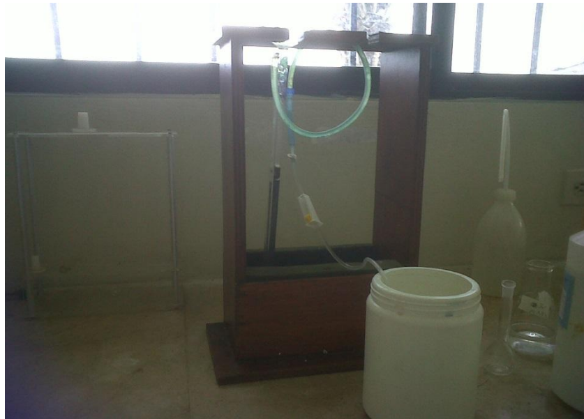
Foto 13.- Columna de cadmio utilizada para nitratos
