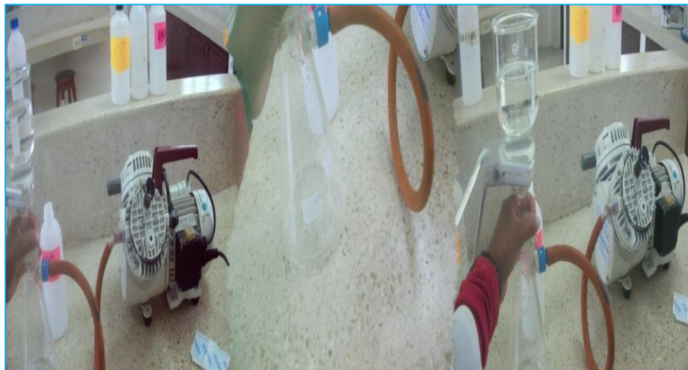
Foto 12.- Filtración de las muestras de agua para realizar los análisis químicos (Nutrientes)
