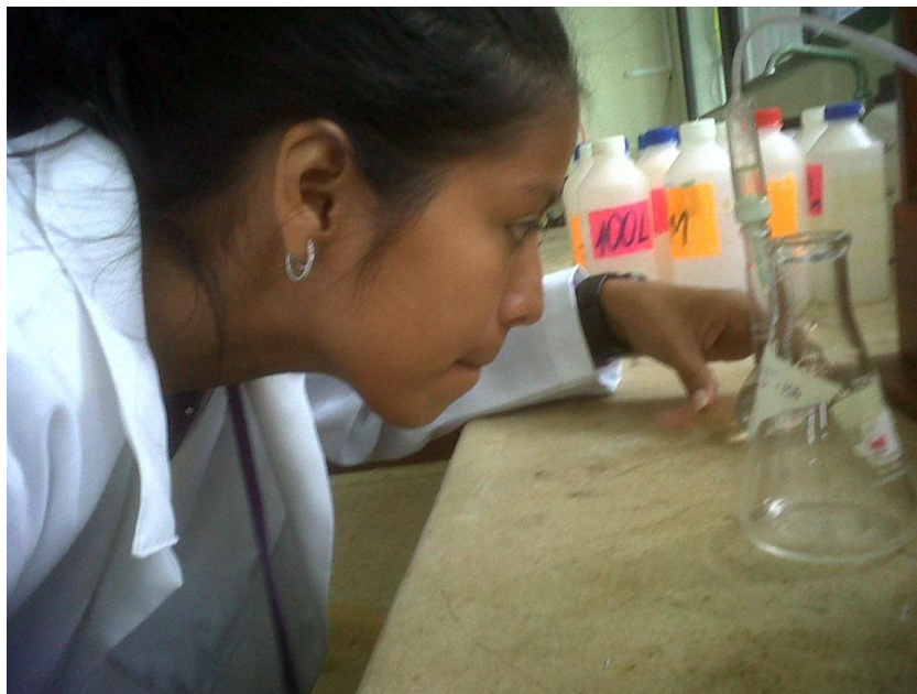
Foto 14.- Obtención de 25 ml de muestra para análisis de nitrato
