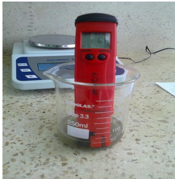
Foto 3. Determinación de pH
