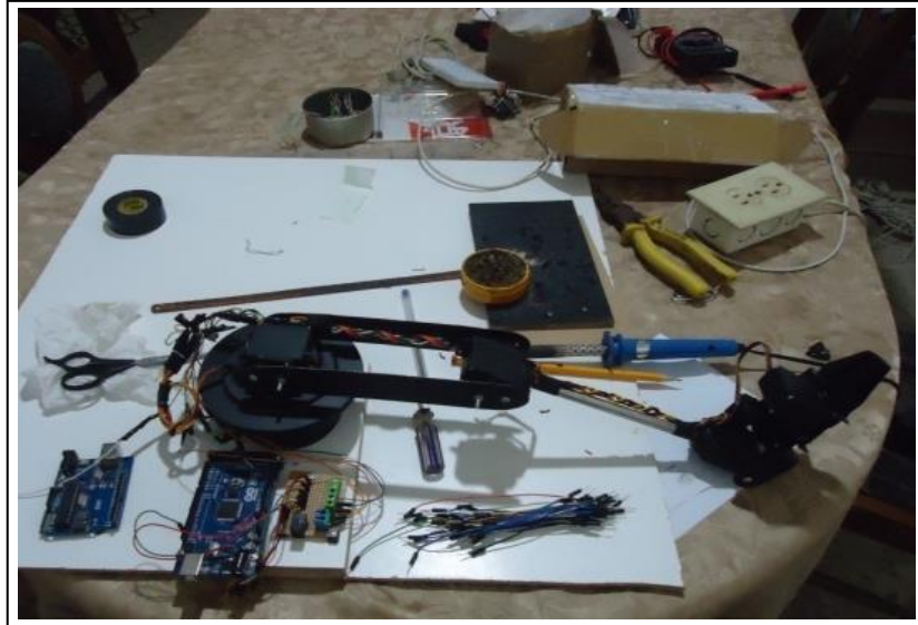
Figura 5.4: Construcción del Brazo Robot. Fuente: Nelson David de la Rosa M.
