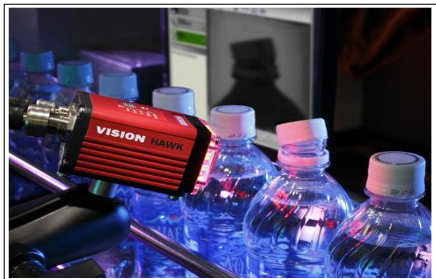
Figura 2.1: Control de Calidad para Botellas Mediante VA.
