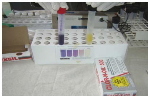
Imagen N° 6.- Resultado de la Prueba de PCB´s
