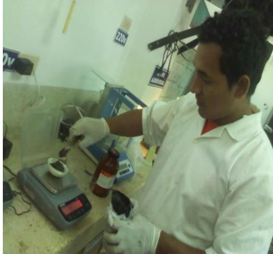
*Foto 4 Determinación de humedad en los diferentes sustratos, en laboratorio de química de la UPSE*
