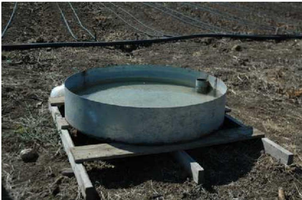
Figura 7A. Colocación de la Tina de evapotranspiración clase A
