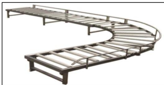
**Figura 23. Transportador de rodillo.**
