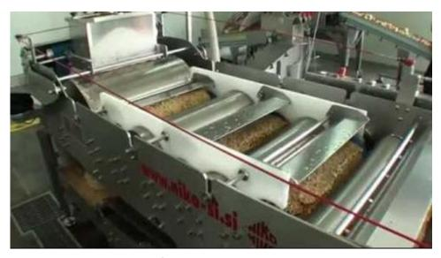
FIGURA 3 DESFIBRADORA DE CASCARA
