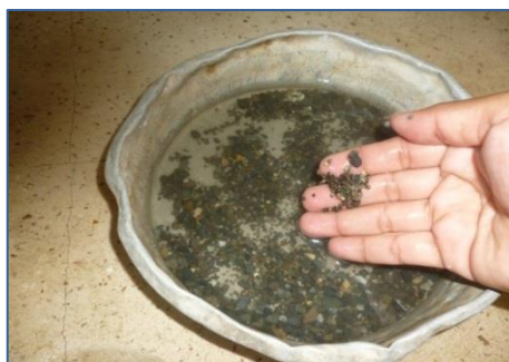
Figura 3.14: Partículas desmenuzables-agregado fino. Fuente: K. Escalante, V. Avila.
