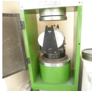
Colocación en dispositivo de fijación
