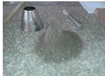
Verificación de humedad superficial
