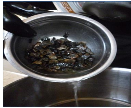
Figura 3.15. Decantado de partículas livianas presentes en el agregado. Fuente: K. Escalante, V. Avila.
