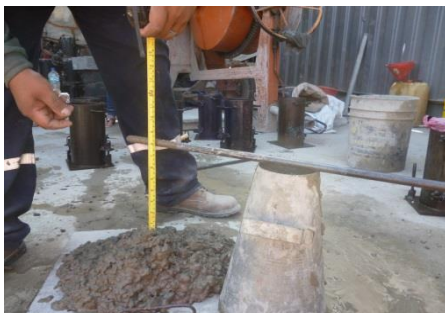
Medición de asentamiento de la mezcla
