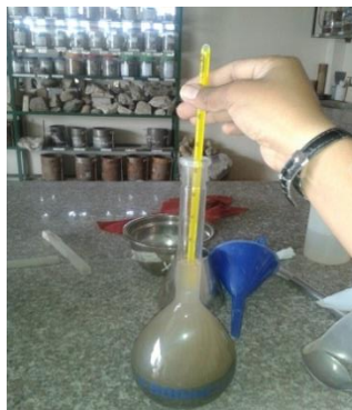
Control de temperatura
