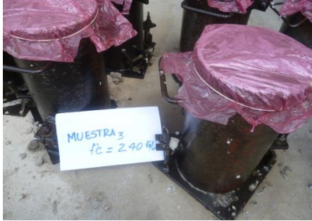
Protección de cilindros - Ingeotop
