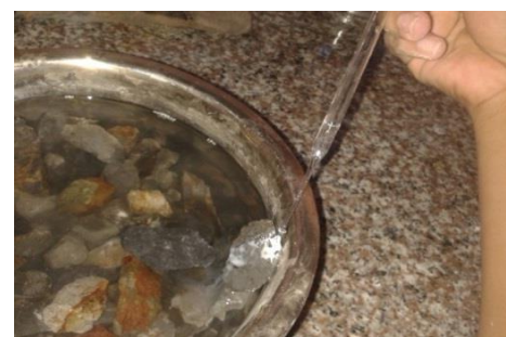
Comprobación de presencia de sulfatos por medio de cloruro de bario
