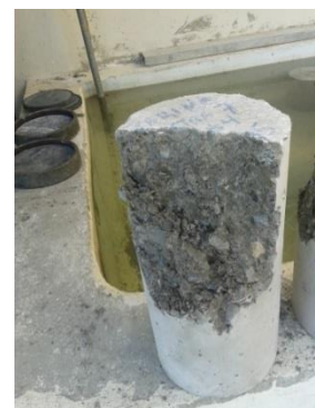
Figura 4.20: Tipo de fractura en probetas de ensayo Fuente: K. Escalante, V. Avila
