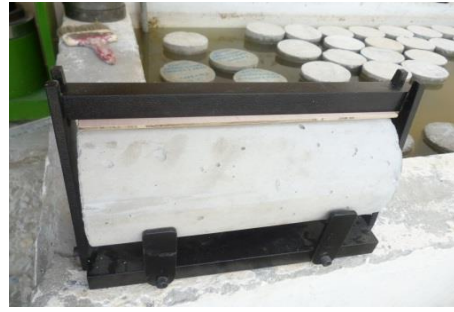
Colocación en dispositivo de fijación
