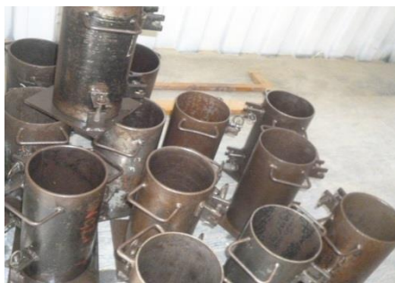
Moldes para elaboración de cilindros - Ingeotop
