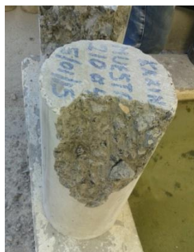
Figura 4.19: Tipo de fractura en probetas de ensayo Fuente: K. Escalante V. Avila
