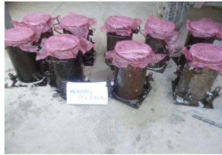
Protección de cilindros - Ingeotop
