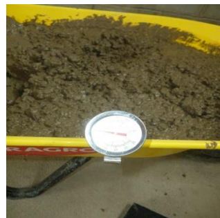
Colocación de termómetro en la mezcla fresca
