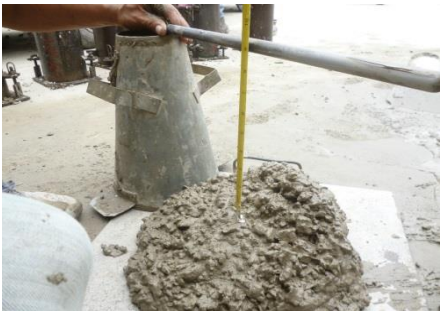
Medición de asentamiento de la mezcla
