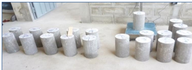
Figura 2.6. Muestras cilíndricas de hormigón. Fuente: K. Escalante, V. Avila
