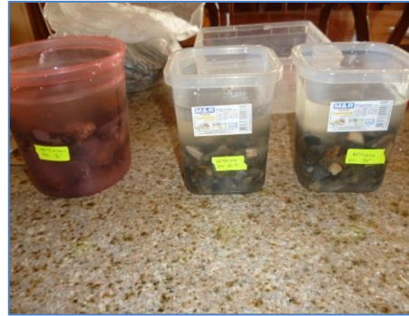
Figura 3.19: Desgaste por la acción de sulfatos.
