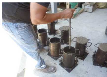
Varillado de capas (Colaboradores de EMUVIAL E.P.)
