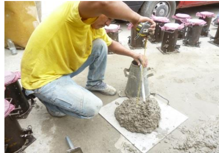
Medición de asentamiento de la mezcla
