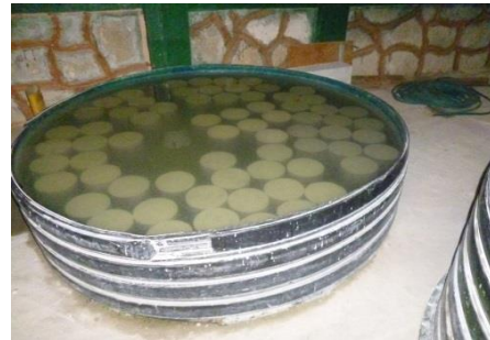
Piscina de curado - Ingeotop
