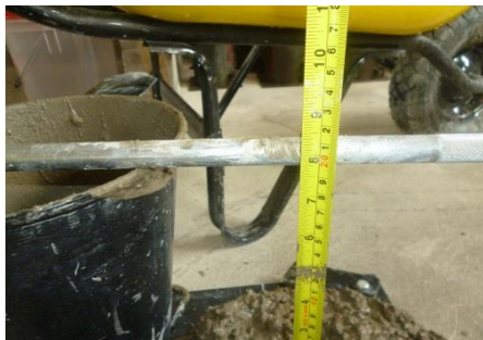
Medición de asentamiento de la mezcla
