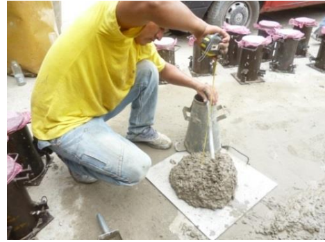
Figura 3.21: Asentamiento del hormigón.
