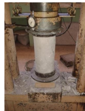
Figura 4.23. Ensayo Módulo de elasticidad. Fuente: K. Escalante, V. Avila
