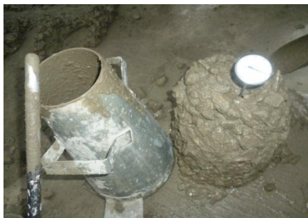
Colocación de termómetro en la mezcla fresca
