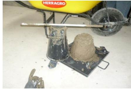
Medición de asentamiento de la mezcla
