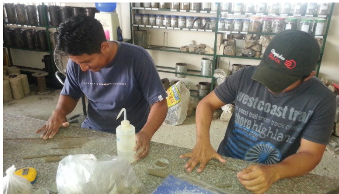
Foto 14 - Ensayo de límite plástico realizado por los autores Mauricio Vera (i) – José Rosales (d)
