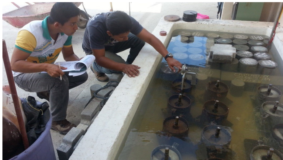
Foto 16- Lectura del hinchamiento en el ensayo de CBR realizada por los autores de la tesis
