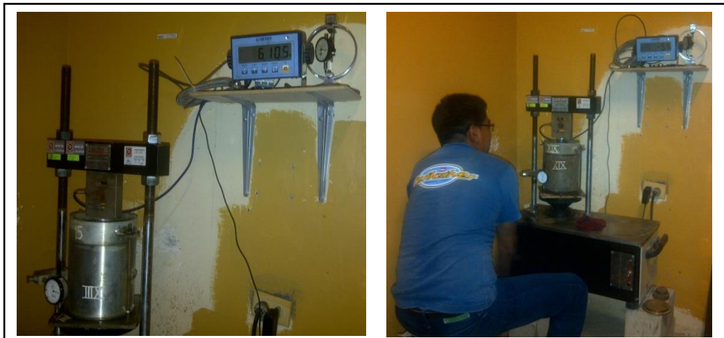
Colocación en la prensa para aplicar el pistón y medir la deformación.
