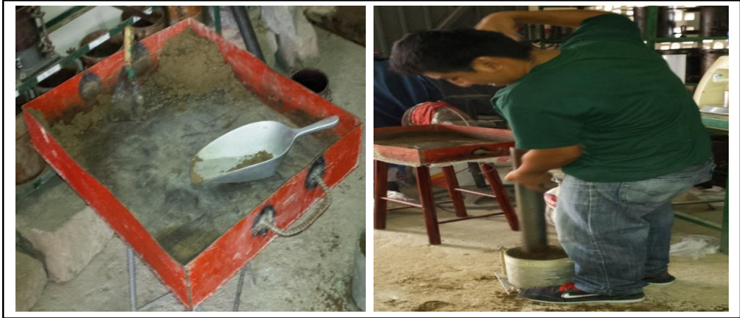
Preparación de la muestra y compactación con el martillo en el molde.
