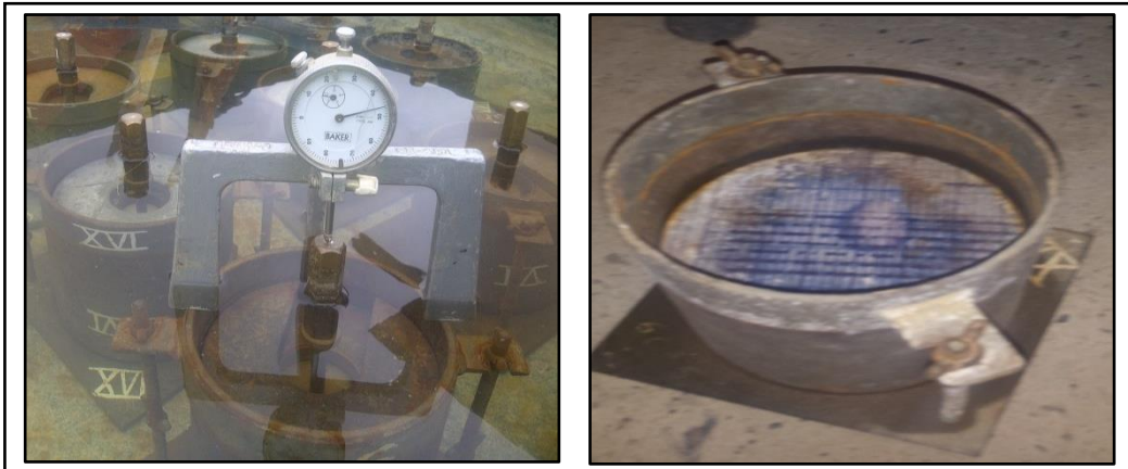
Muestra sumergida en agua y molde una vez cumplido el tiempo de saturación.
