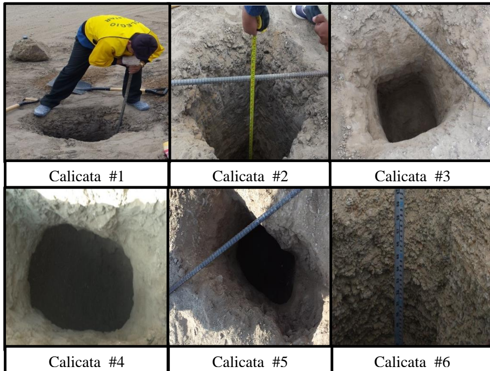
Gráfico N° 15. Calicatas para muestras de suelos. Fuente: Del Pezo - Muñoz
