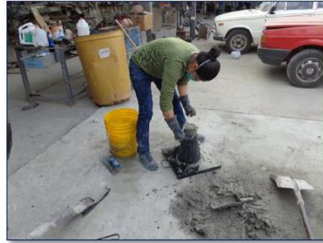
Ilustración 63.- Realizando la prueba de revenimiento. Fuente.- Autor.
