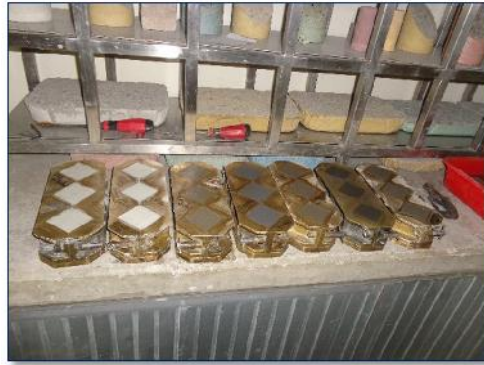
Ilustración 91.-Moldes en el cuarto de curado antes de desencofrar. Fuente.-Autor.
