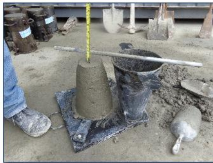
Ilustración 65.- Midiendo cuanto se asentó la mezcla. Fuente.- Autor.
