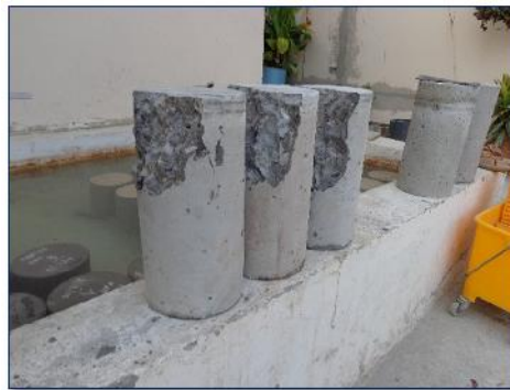
Ilustración 74.- Tipos de rotura de los cilindros. Fuente.- Autor.
