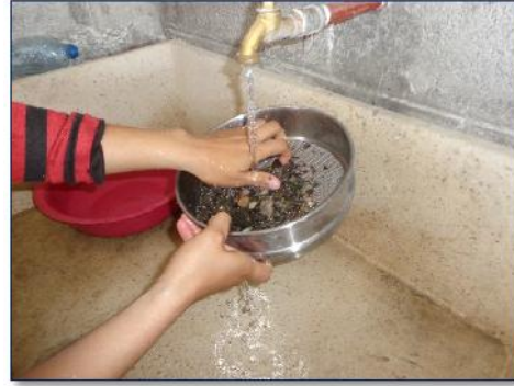
Ilustración 37.- Lavado del agregado sobre el tamiz de 850 micras (N° 20). Fuente.- Autor.
