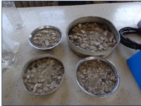
Ilustración 38.- Agregado grueso sumergido por 24 horas en agua destilada. Fuente.- Autor.
