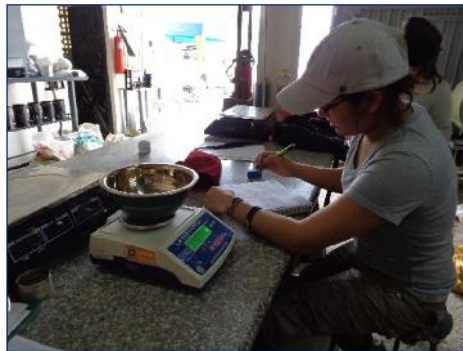
Ilustración 57.- Granulometría, peso del material retenido. Fuente.- Autor.
