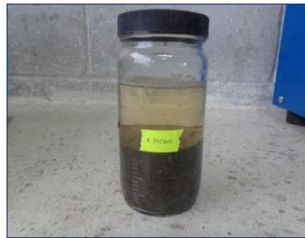
Ilustración 18.- Agregado fino en la solución de hidróxido de sodio Fuente.- Autor
