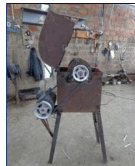
Ilustración 8.- Molino de martillos fabricado por el autor Fuente: Autor
