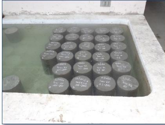
Ilustración 69.- Cilindros de hormigón en la piscina de curado. Fuente.- Autor.
