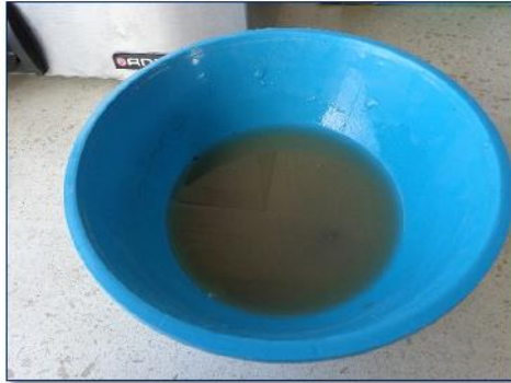
Ilustración 41.- Agregado fino sumergido en la solución de óxido de zinc. Fuente.- Autor.
