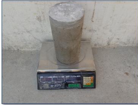
Ilustración 71.- Pesando los cilindros antes de la rotura. Fuente.- Autor.
