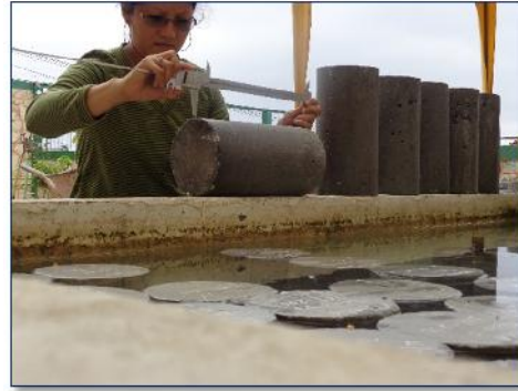
Ilustración 70.- Midiendo los cilindros, diámetro y altura. Fuente.- Autor.
