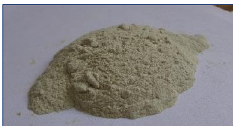
Ilustración 12.- Polvo de vidrio ámbar tamizado pasante malla #100. Fuente: Autor.
