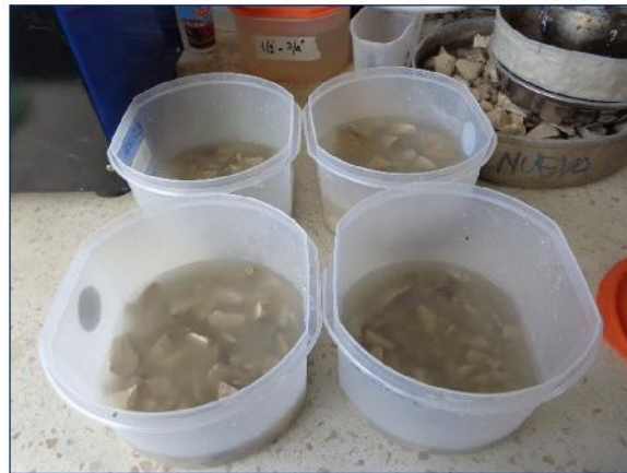
Ilustración 54.- Agregado grueso en la solución de sulfato de magnesio. Fuente.- Autor.
