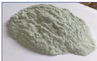
Ilustración 13.- Polvo de vidrio verde tamizado pasante malla #200. Fuente.- Autor
