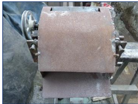
Ilustración 9.- Molino de rodillos fabricado por el autor Fuente: Autor
