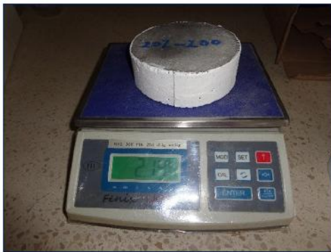
Ilustración 89.-Peso del cilindro superficialmente seco. Fuente.-Autor.
