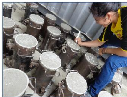
Ilustración 68.- Identificando los cilindros de hormigón. Fuente.- Autor.
