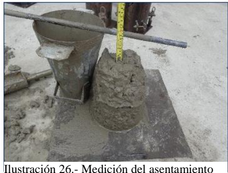
Ilustración 26.- Medición del asentamiento Fuente.- Autor
