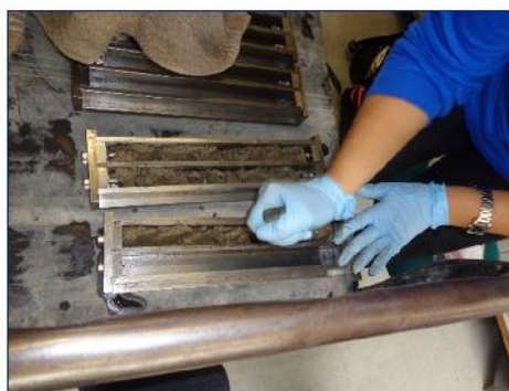
Ilustración 30.- Llenado de las barras.
