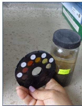
Ilustración 50.- Muestra con el comparador de color normalizado, corresponde al color 1. Fuente.- Autor.
