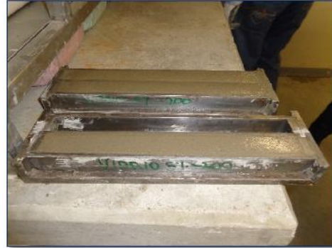
Ilustración 82.- Barras en el cuarto de curado. Fuente.- Autor.
