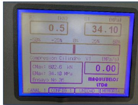
Ilustración 73.- Resultados del ensayo de compresión. Fuente.- Autor.
