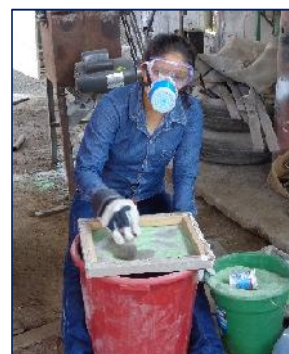
Ilustración 10.- Tamizado del material malla #200. Fuente.- Autor.
