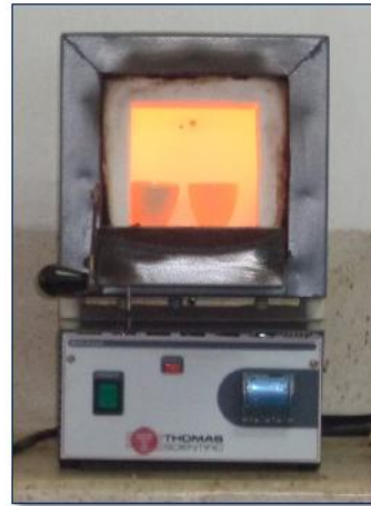
Ilustración 93.-Muestra en la mufla a 950°C Fuente.-Autor.
