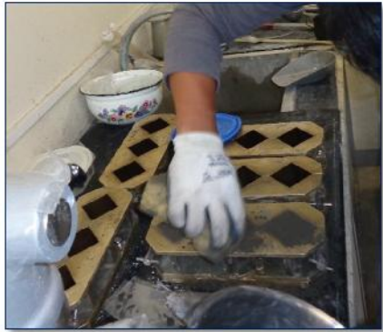
Ilustración 90.-Llenado de los moldes cúbicos. Fuente.-Autor.
