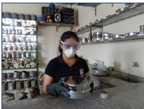
Ilustración 11.- Tamizado del material malla #100. Fuente.- Autor.
