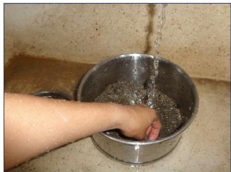
Ilustración 14.- Lavado del material sobre tamiz 200
