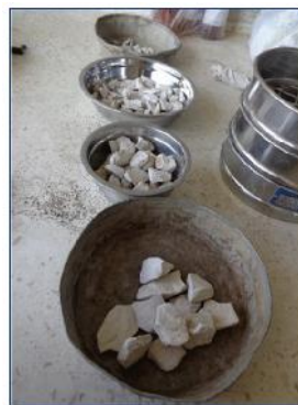
Ilustración 19.- Muestras para realizar el ensayo de abrasión Fuente.- Autor
