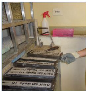
Ilustración 80.- Desencofrando. Fuente.- Autor.
