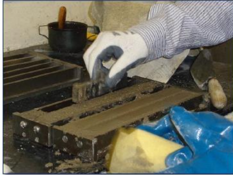
Ilustración 83.- Llenado las barras con la mezcla. Fuente.- Autor.
