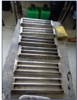
Ilustración 76.- Moldes para realizar las barras. Fuente.- Autor.
