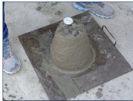
Ilustración 66.- Tomando la temperatura de la mezcla. Fuente.- Autor.
