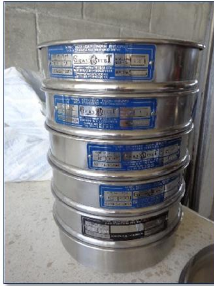
Ilustración 51.- Tamices para determinar el tamaño de la muestra.
