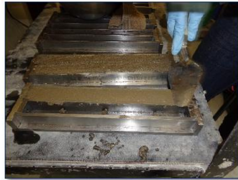
Ilustración 78.- Nivelando la superficie de las barras. Fuente.- Autor.
