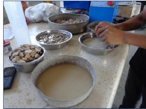
Ilustración 39.- Apretando y rodando las con los dedos el agregado de forma individual. Fuente.- Autor.
