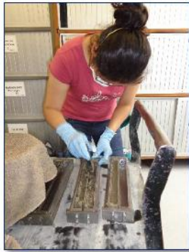
Ilustración 77.- Llenando los moldes con la mezcla. Fuente.- Autor.
