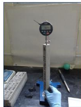
Ilustración 79.- Midiendo las barras. Fuente.- Autor.
