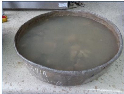
Ilustración 42.- Agregado grueso sumergido en la solución de óxido de zinc. Fuente.- Autor.
