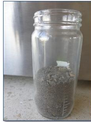
Ilustración 47.- 130 cm 3 de agregado fino aproximadamente. Fuente.- Autor.
