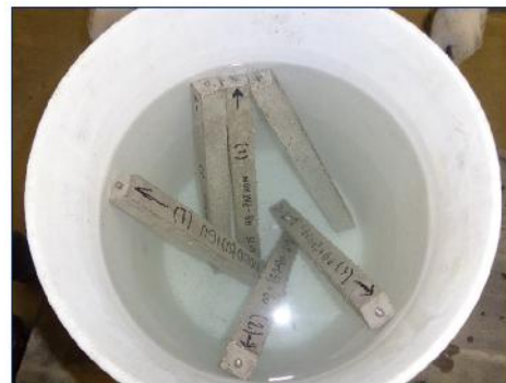
Ilustración 85.- Barras sumergidas en la solución. Fuente.- Autor.
