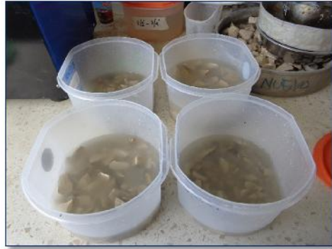
Ilustración 20.-Muestra sumergida en la solución de sulfato de magnesio.
