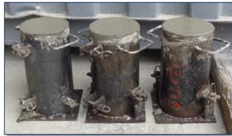
Ilustración 31.- Cilindros llenos de hormigón. Fuente.- Autor
