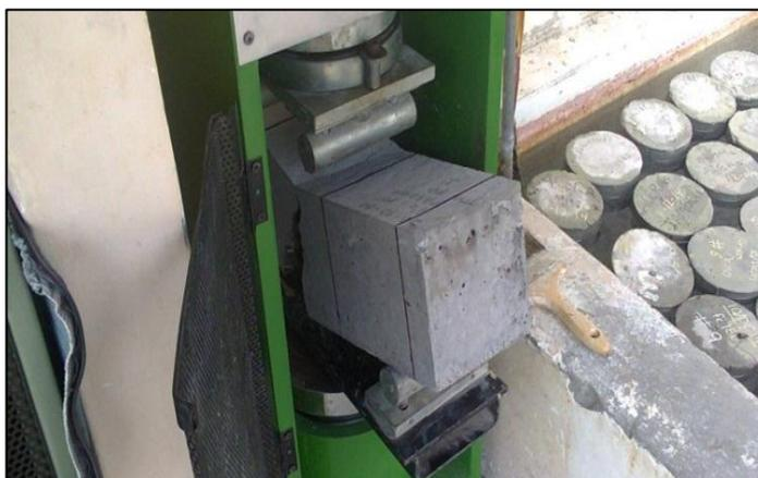
Foto 3.15 - Ensayo de resistencia a flexión del hormigón.
