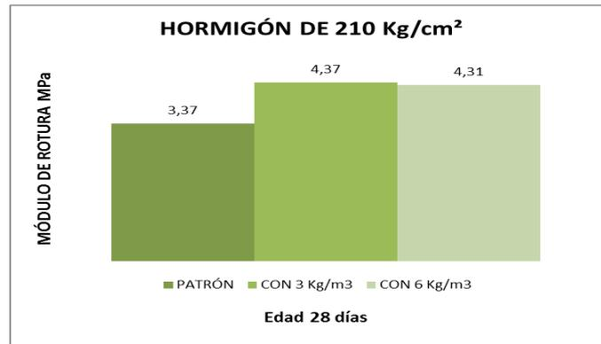
Gráfica 4.13 - Resistencias a flexión de mezclas: patrón, con adición de 3 y 6 kg/m<sup>3</sup> de fibras de PP. Diseño 210 Kg/cm<sup>2</sup>.
