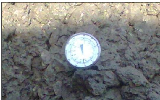
Foto 3.12 - Medición de la temperatura del hormigón.
