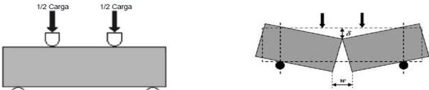
ASTM C78. Cargas en los puntos tercios. La mitad de la carga se aplica en cada tercio de la luz. El módulo de rotura es más bajo que en el caso de la carga en el punto medio. La tensión máxima en el tercio medio de la viga.
