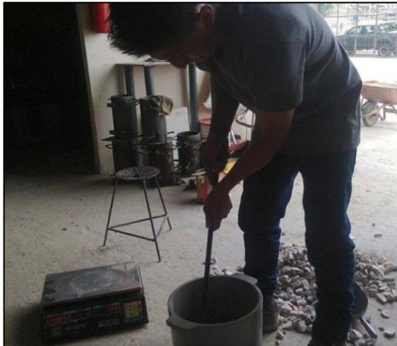
Peso volumétrico varillado del agregado
