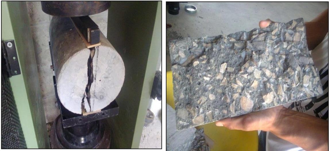
Roturas de cilindros a tracción
