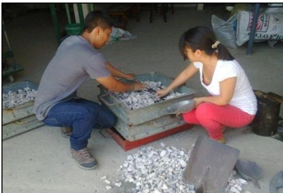
Foto 3.1 - Granulometría del agregado grueso
