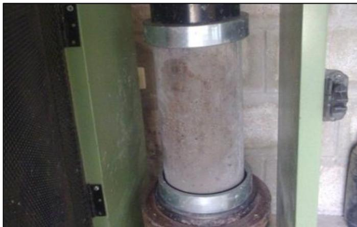
Foto 3.14 - Ensayo de resistencia a la compresión del hormigón.
