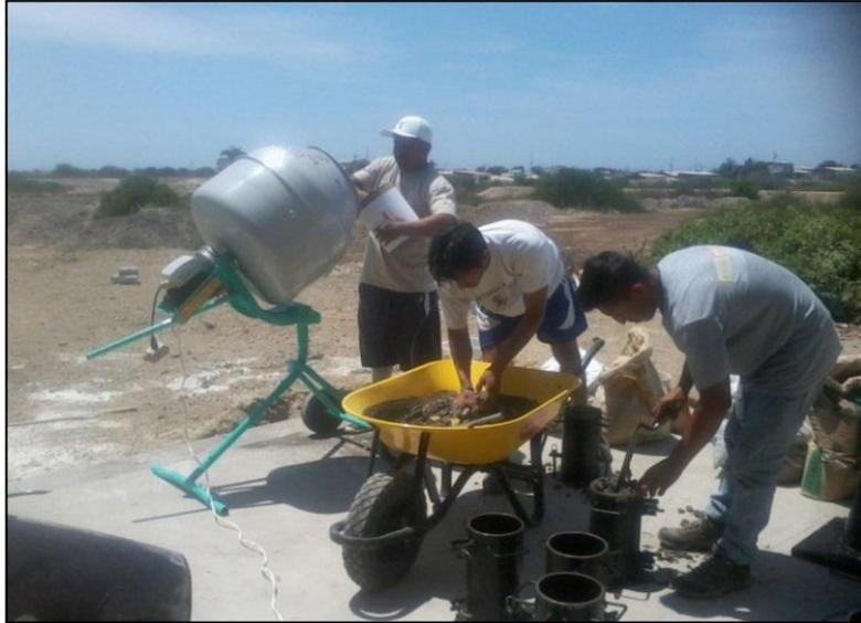
Elaboración de cilindros y vigas de hormigón
