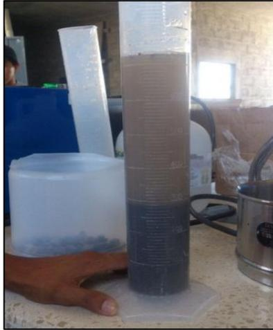
Foto 3.9 – Ensayo de partículas en suspensión del agregado fino.
