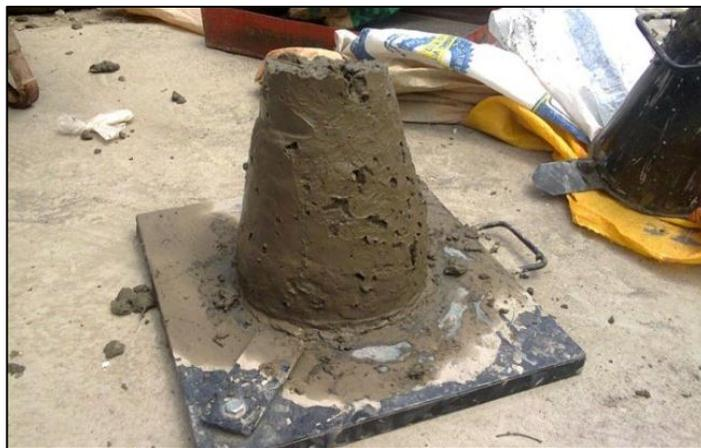
Foto 3.13 – Revenimiento del hormigón.
