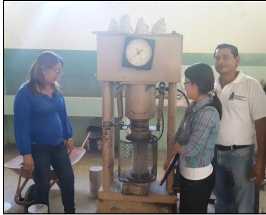
Foto 3.17 - Modulo elástico del Hormigón.
