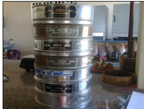
Foto 3.2 - Granulometría del agregado fino.
