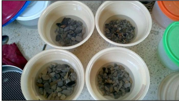
Foto 3.10 - Solidez del agregado grueso mediante el uso de sulfato de magnesio.
