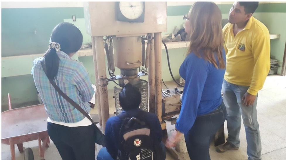
Módulo elástico del hormigón
