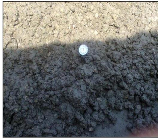
Temperatura del hormigón
