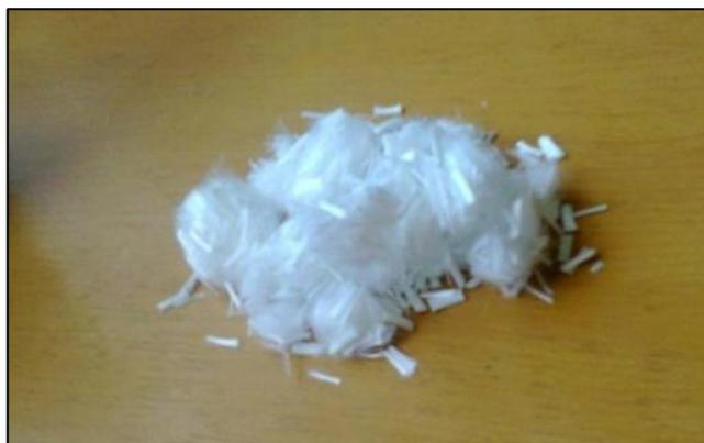
Foto 2.5 - Fibras tipo monofilamento
