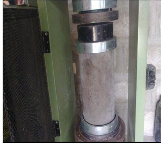
Colocación de la probeta para ensayo
