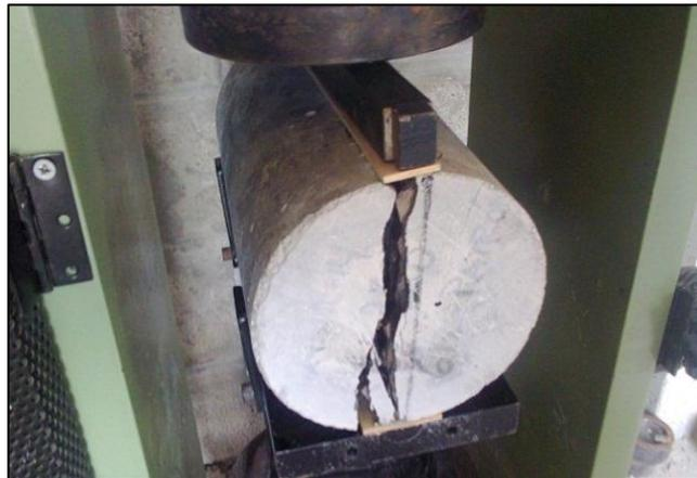
Foto 3.16 - Ensayo de resistencia a tracción del hormigón.
