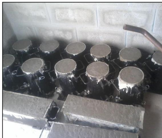
Elaboración de cilindros y vigas de hormigón
