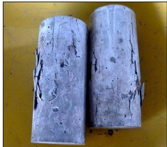
Roturas de cilindros a compresión
