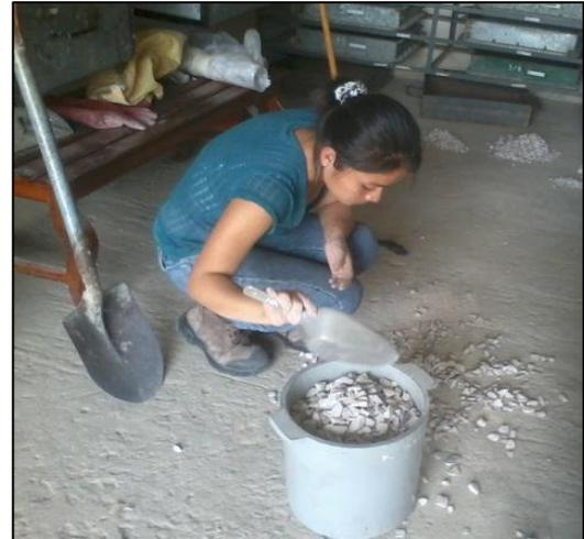
Peso volumétrico suelto del agregado
