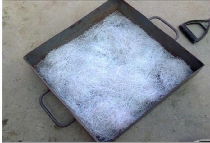
Foto 2.4 - Fibras de polipropileno utilizadas.
