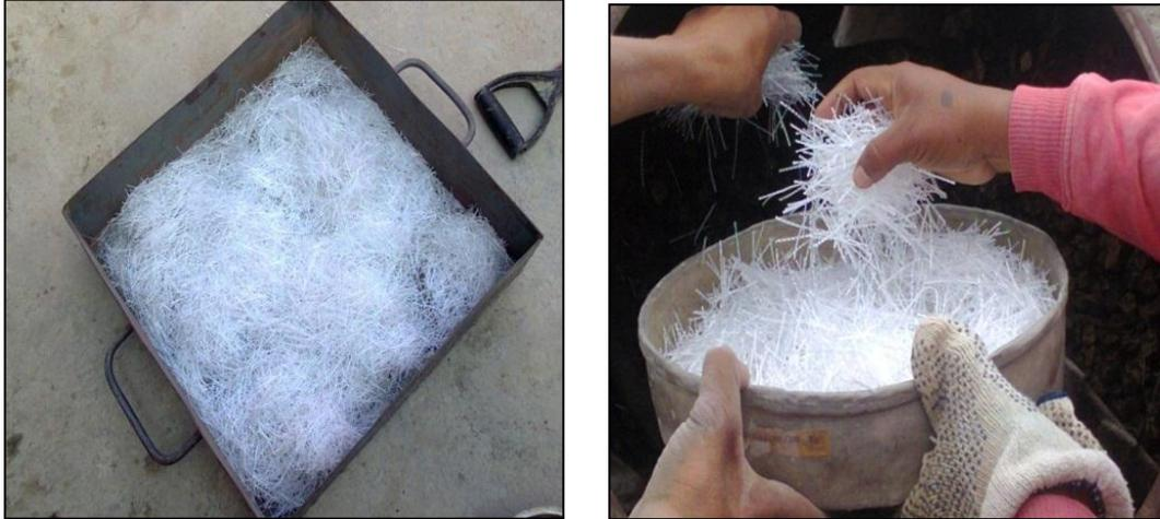
Fibras de polipropileno utilizadas
