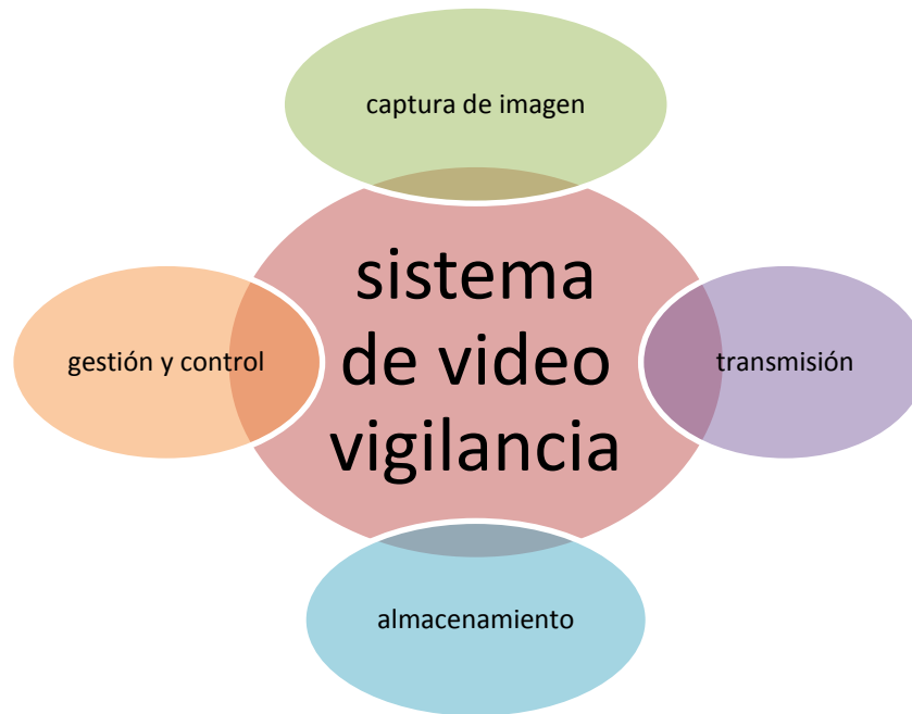
Figura 10: Proceso de un Sistema de video vigilancia IP: Autor.
