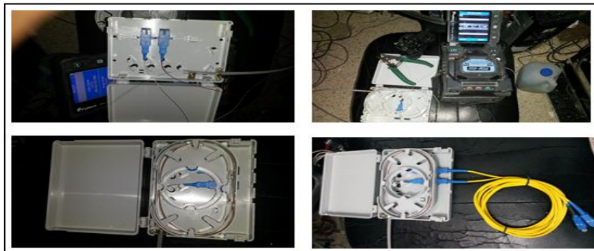
Figura 38: Construcción del Mini- ODF: Autor.
