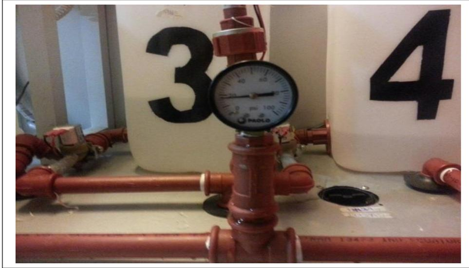
**Figura 50:** Verificación de la presión generada por el caudal: Autor.
