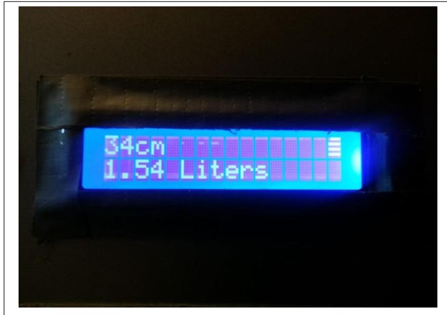
**Figura 52:** Presentación en LCD del volumen prueba. : Autor
