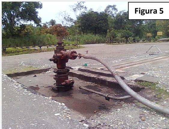
*Imagen de la perforación del pozo Lago Agrio 01, año 1967 (figura 2 y 3); pozo en producción, año 2000 (figura 4); y abandono, año 2011 (figura 5).*
