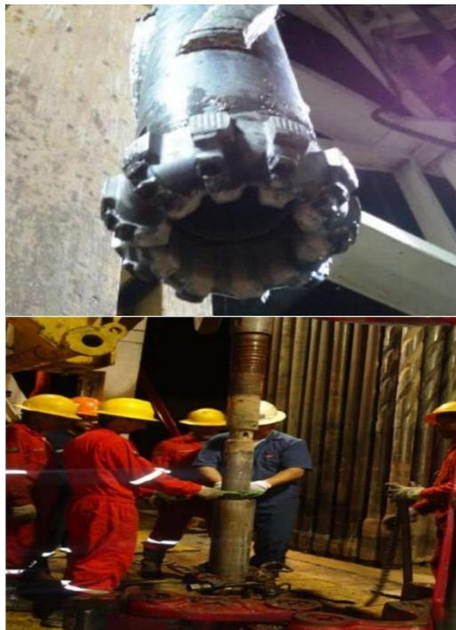
**Fig. 59. Broca # 6 LC-104 de 8 ½” del Campo Centro Oriente Sacha – X3 broca sale a superficie mantiene su diámetro nominal**
