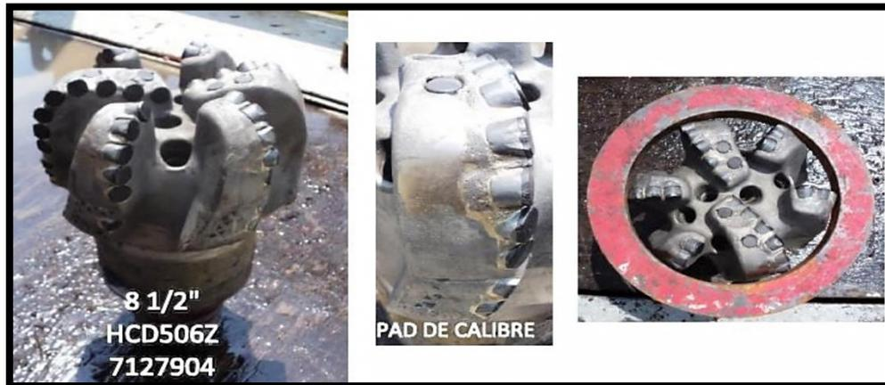
Fig. 22. Broca 8 1/2" y Pad de Calibre
