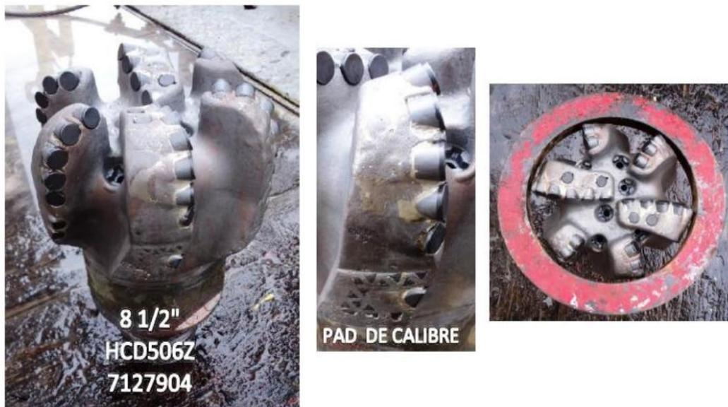
**Fig. 58. Broca # 5 HCD506Z de 8 ½” del campo Centro Oriente Sacha – X3, Pad del Calibre**
