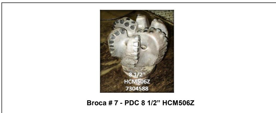
**Fig. 47. Brocas usadas en el campo Centro Oriente Sacha-X6**
