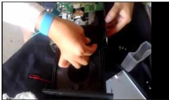
ILUSTRACIÓN 64: Limpieza externa del CD-ROM.
