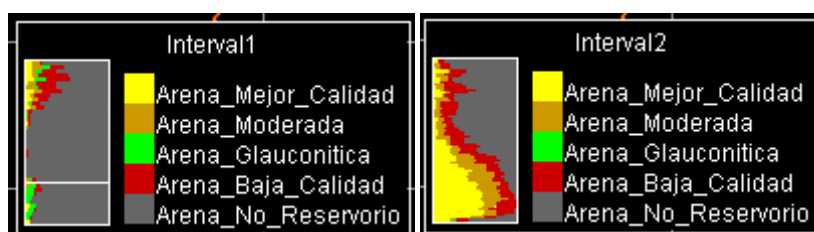
Figura 3.8. Ejemplos de Curvas de Proporción Vertical Fuente: Software Decision Space (DSG)
