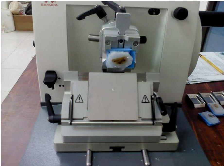
**Figura 67.** Bloque de parafina listo para ser cortado en el Micrótopomo (Yagual, J. 2015).
