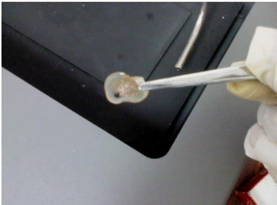
**Figura 69.** Los cortes de las muestras son colocados en el baño de flotación (Yagual, J. 2015).
