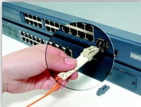
Figura 30 Módulos de Fibra Óptica
