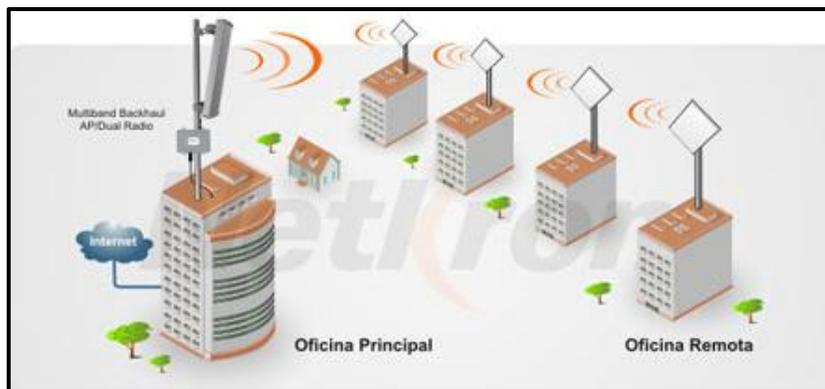
**Figura 6:** Conexión de enlace punto – multipunto.
