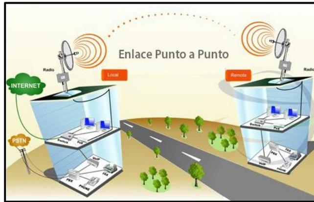
**Figura 5:** Conexión de enlace punto a punto.
